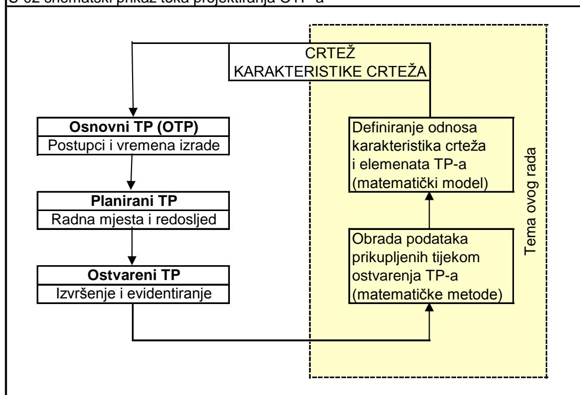
**Slika 1.2** Dijagram toka projektiranja osnovnog TP-a
