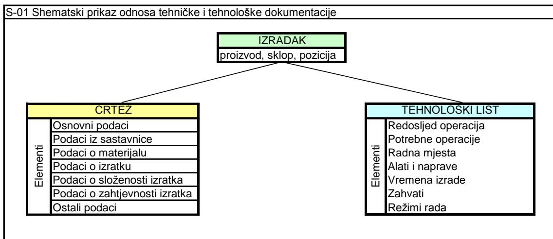
**Slika 1.1** Shematski prikaz povezanosti crteža i tehnološkog procesa
