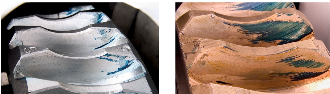
Slika 9.1 Kontrola slike nošenja indigo pastom; prvo podešavanje bez opterećenja AlSn6 kola (lijevo) i CuSn12 kola (desno)
