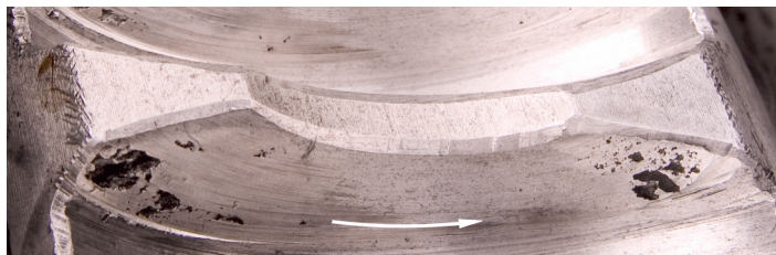
Slika 5.7 Pojava rupičenja i na ulaznoj strani zuba kod loše slike nošenja
