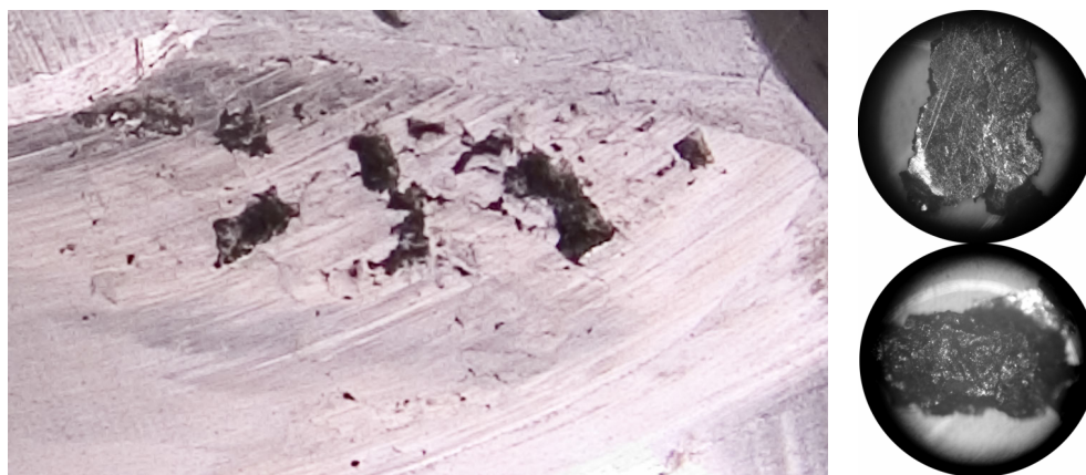
Slika 5.6 Rastrešenost površine boka (lijevo) i odvojene čestice (desno)
