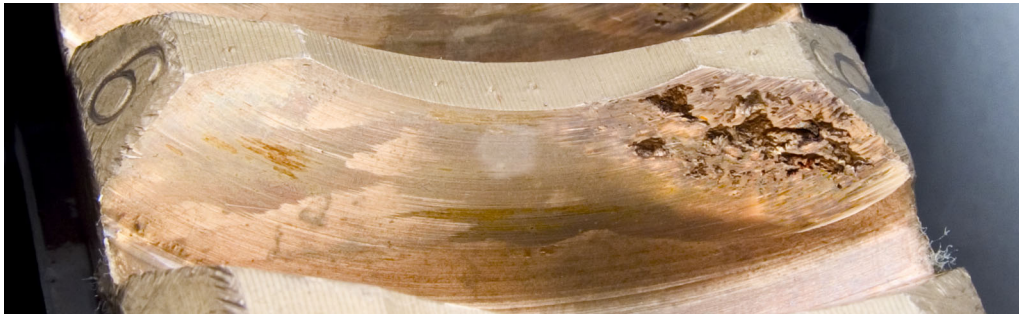
Slika 10.5 Zub br. 6 pužnog kola CuSn12 nakon 4,67 \cdot 10^6 izmjena
