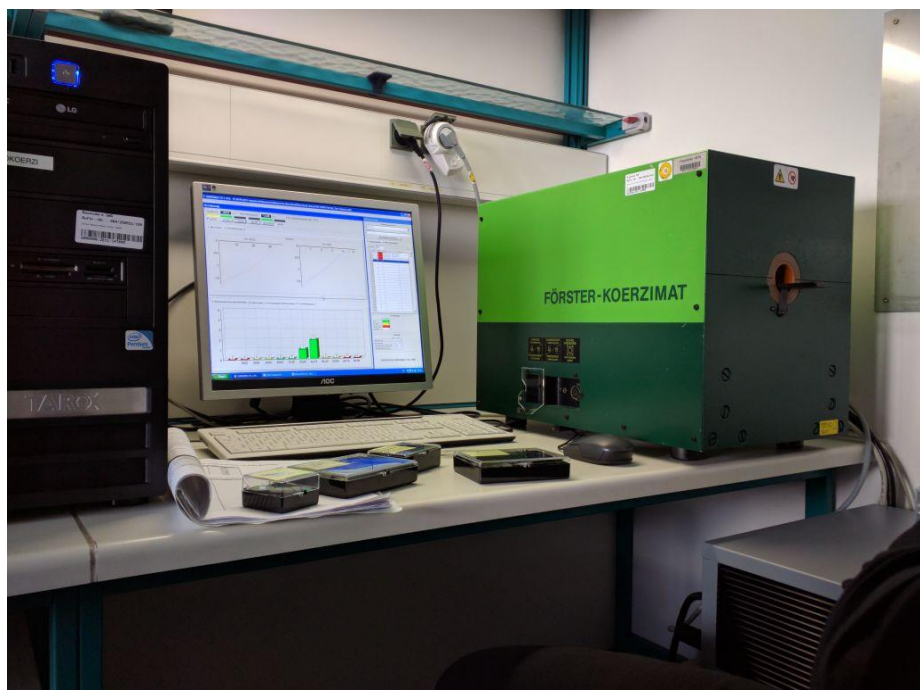
Slika 5.10 Uređaj za mjerenje koercitivnih sila
