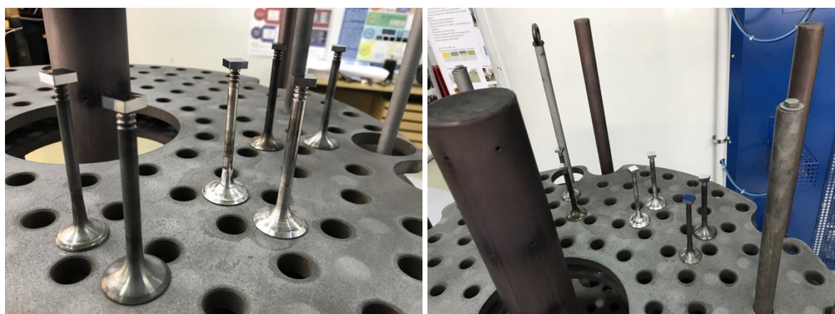
Slika 5.48 Pozicioniranje uzoraka unutar komore za prevlačenje
