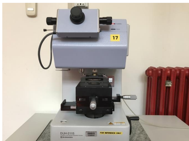
Slika 5.22 Uređaj za ispitivanje instrumentiranom metodom indentacije DUH 211S
