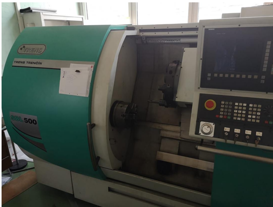
Slika 5.85 Tokarski obradni centar SBL 500
