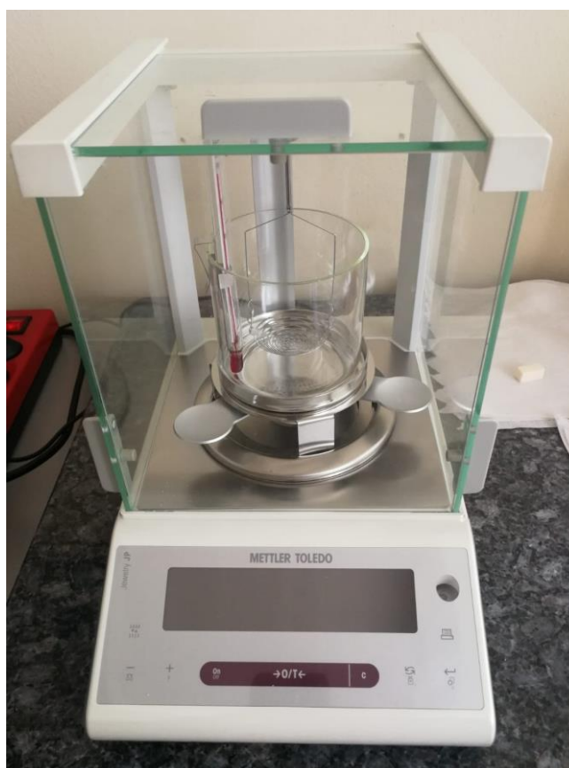
Slika 5.8 Uređaj za mjerenje gustoće Metler Toledo
