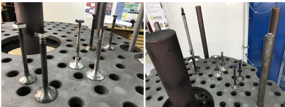
Slika 5.48 Pozicioniranje uzoraka unutar komore za prevlačenje
