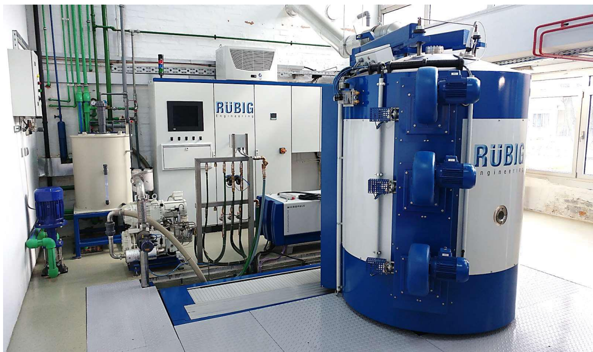
Slika 5.47 Uređaj za PACVD prevlačenje Rübige PC 70/90
