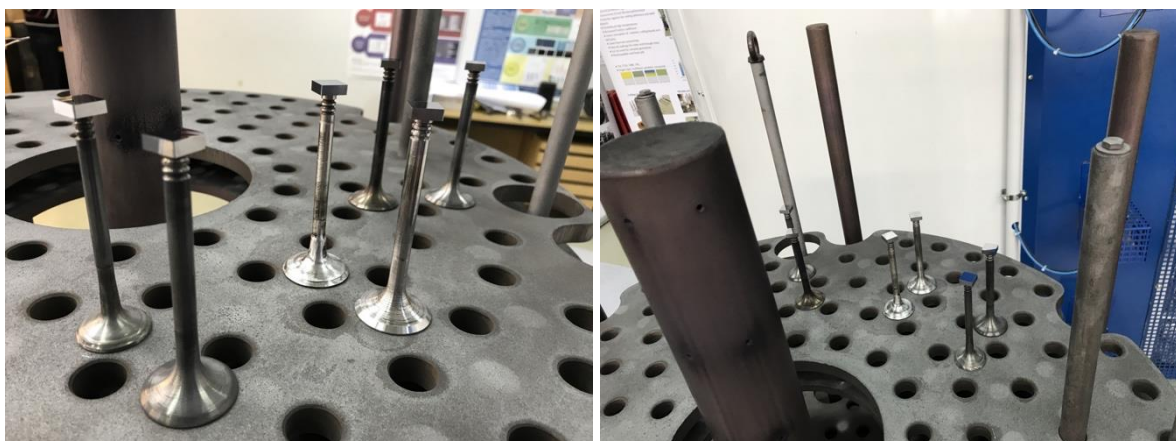
Slika 5.48 Pozicioniranje uzoraka unutar komore za prevlačenje
