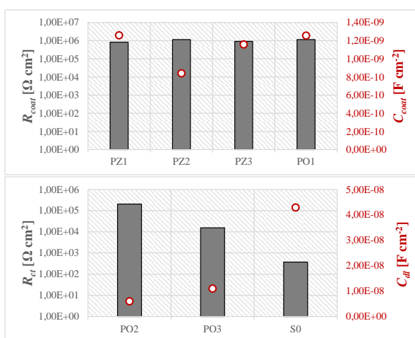
Otpori R_{coat} i R_{ct} kapaciteti C_{coat} i C_{dl} – izloženost 360 h
