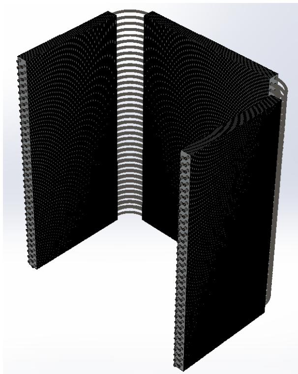
**Slika 36. 3D prikaz isparivača (računalni program "SolidWorks")**
