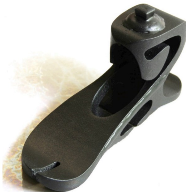
Slika 16. Proteza noge izrađena od PLA materijala [30]
