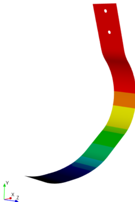
Slika 23. Debljina [mm] kompozitne proteze nakon uklanjanja slojeva pomoću Cut-Off pravila
