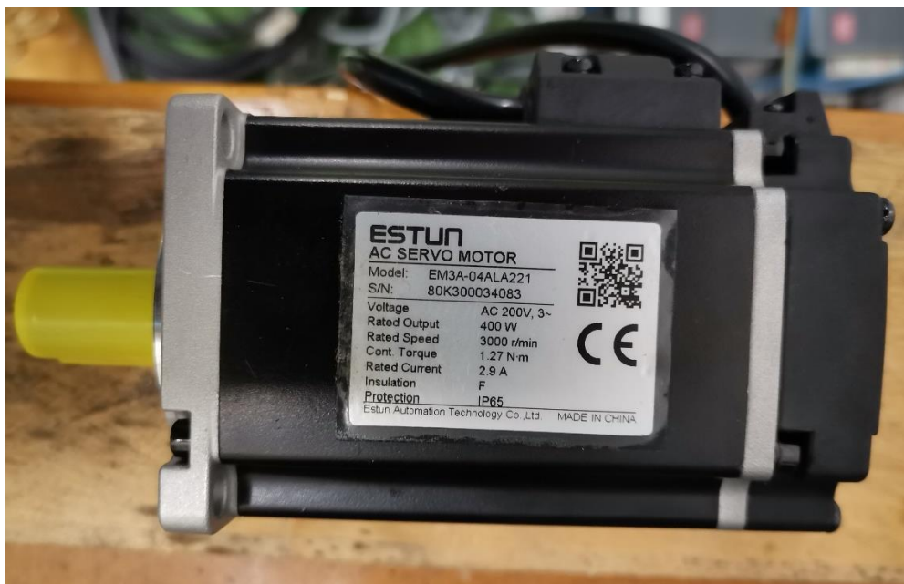
Slika 22. Servomotor ESTUN EM3A-04ALA221
