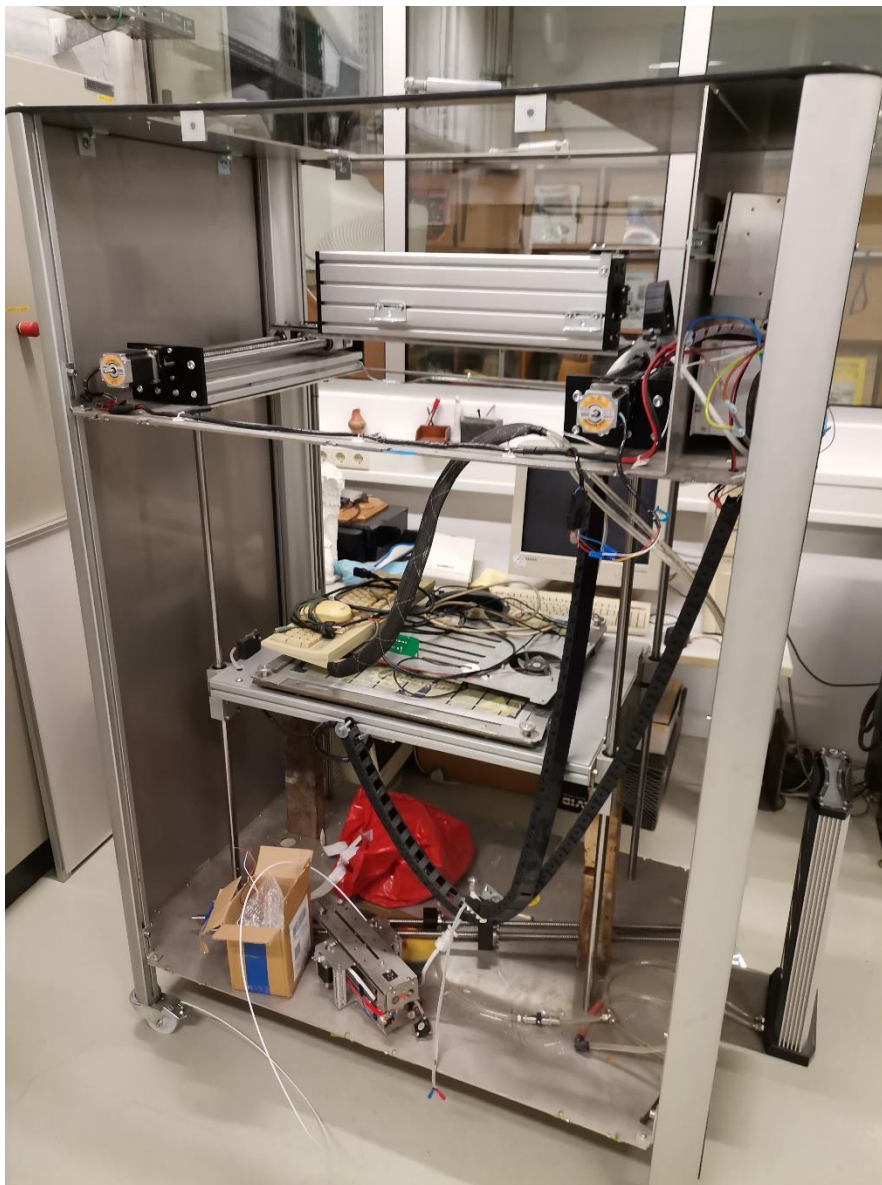
Slika 14. 3D pisač velikog radnog volumena
