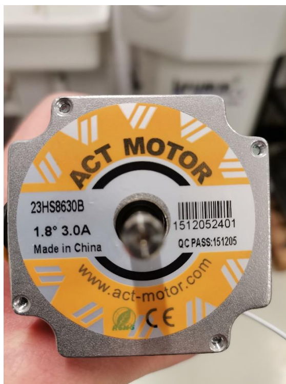
Slika 15. Koračni motor 3D pisača
