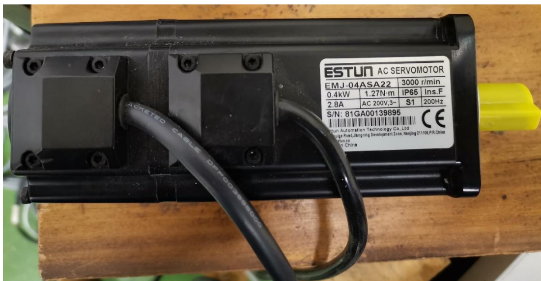
Slika 20. Servomotor ESTUN EMJ-04ASA22
