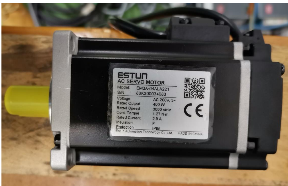
Slika 22. Servomotor ESTUN EM3A-04ALA221
