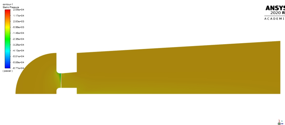
Slika 5.12. Polje statičkog tlaka u meridijalnoj ravnini
