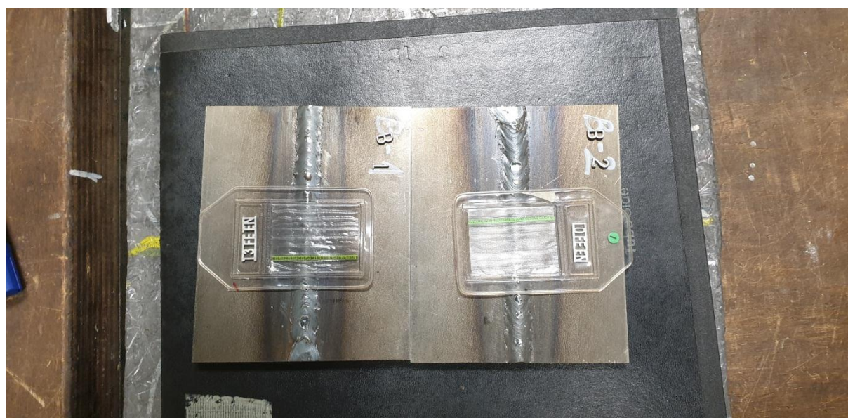
Slika 5.44 Uzorci B-1 i B-2 pripremljeni za rendgensko snimanje
