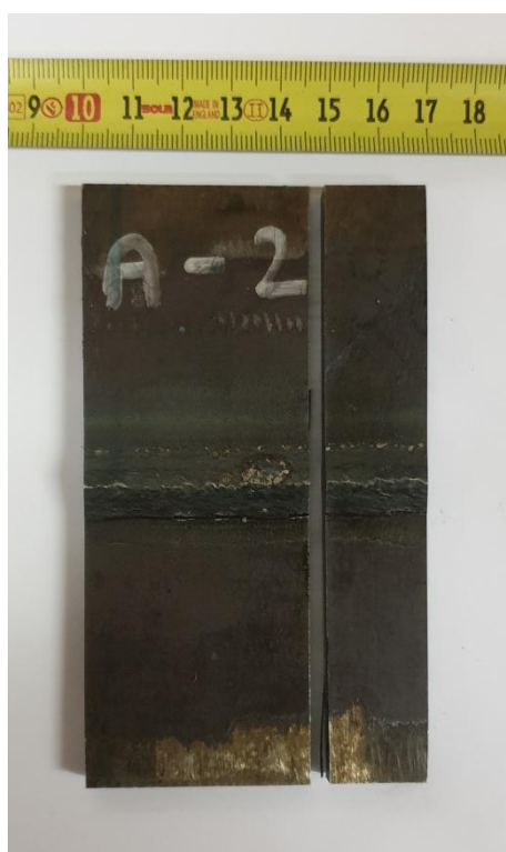
Slika 5.24 Grubo izrezan makroizbrusak iz uzorka A-2
