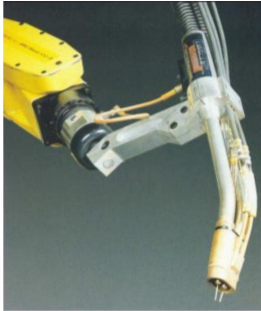
Slika 3.7 Pištolj za tandem postupak zavarivanja [8]
