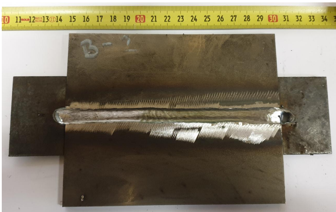
Slika 5.18 Čišćenje površine zavora između prolaza
