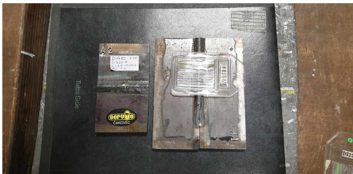
Slika 5.43 Uzorci A-1 i A-2 pripremljeni za rendgensko snimanje
