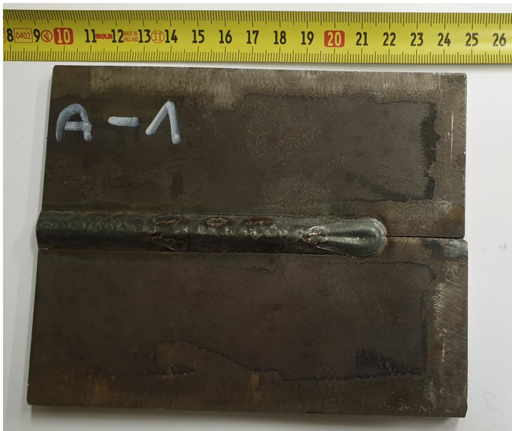
Slika 5.13 Uzorak A-1 nakon provedenog postupka zavarivanja
