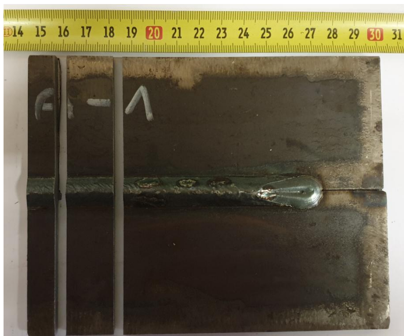
Slika 5.23 Grubo izrezan makroizbrusak iz uzorka A-1
