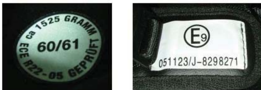
Slika 6.3. Ušivene homologacijske oznake. Na desnoj slici oznaka 60/61 označava veličinu, dok oznaka 1525 označava težinu kacige u gramima.
