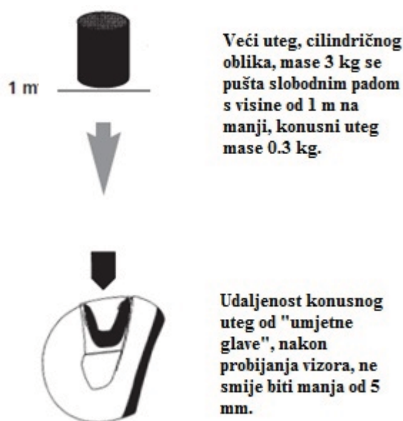
Slika 5.22. Ispitivanje mehaničkih svojstava vizora (penetrirajući test).
