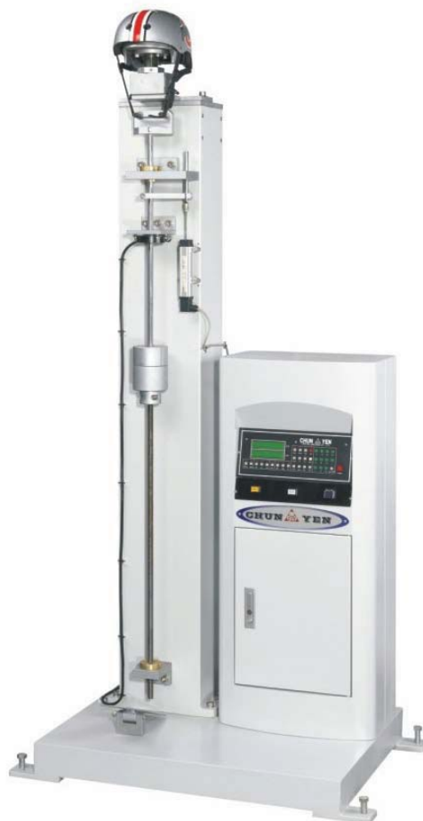
Slika 9.3. Uređaj za ispitivanje dinamičke izdržljivosti sustava vezanja kacige ( Chun Yen ).
