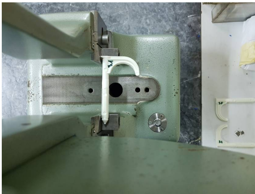
Slika 5.7. Tvorevina pozicionirana na Charpyevom batu
