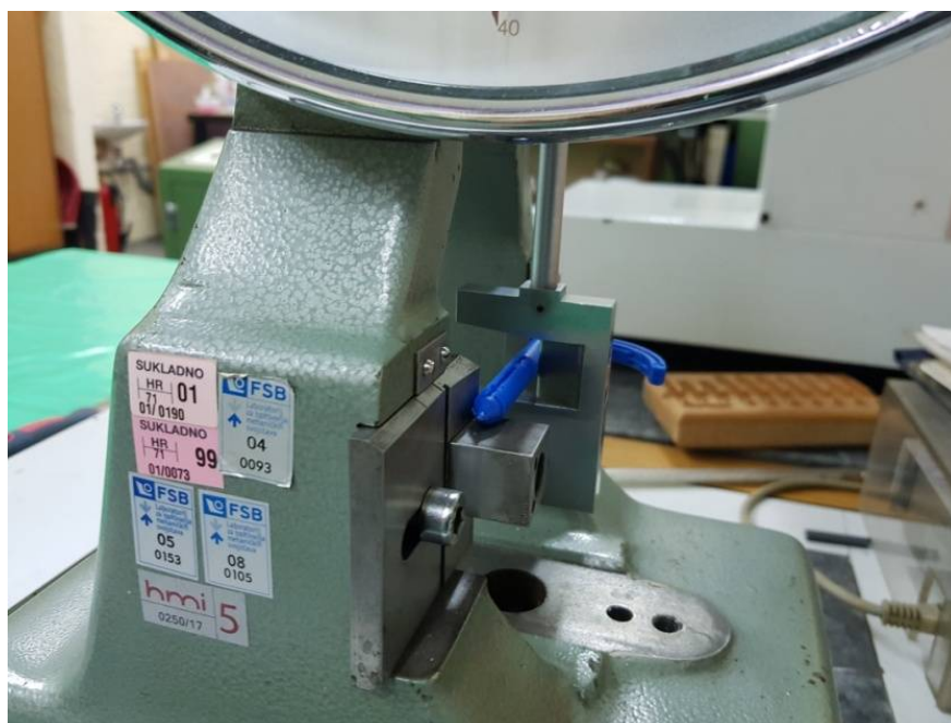
Slika 5.8. Tvorevina pozicionirana za ispitivanje prilikom udara bata
