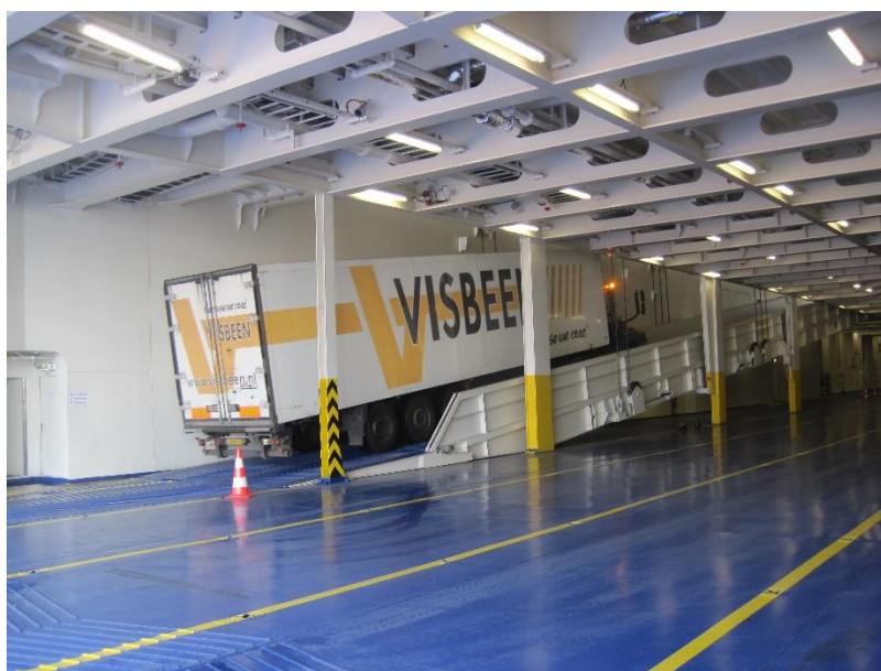
Slika 2. Unutrašnja rampa Ro-Ro broda
