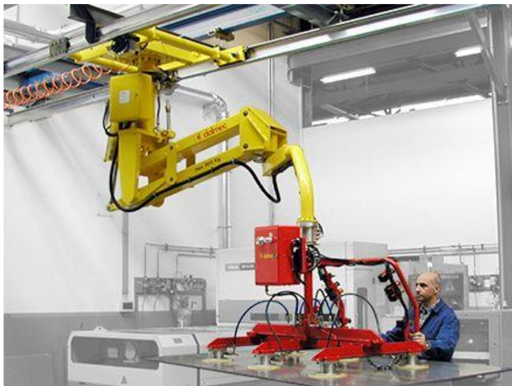
Slika 7. Mobilni stropni manipulator
