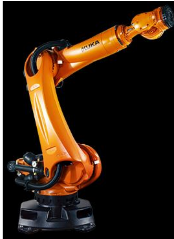
Slika 17. KUKA – KR 180 R3500 ultra K
