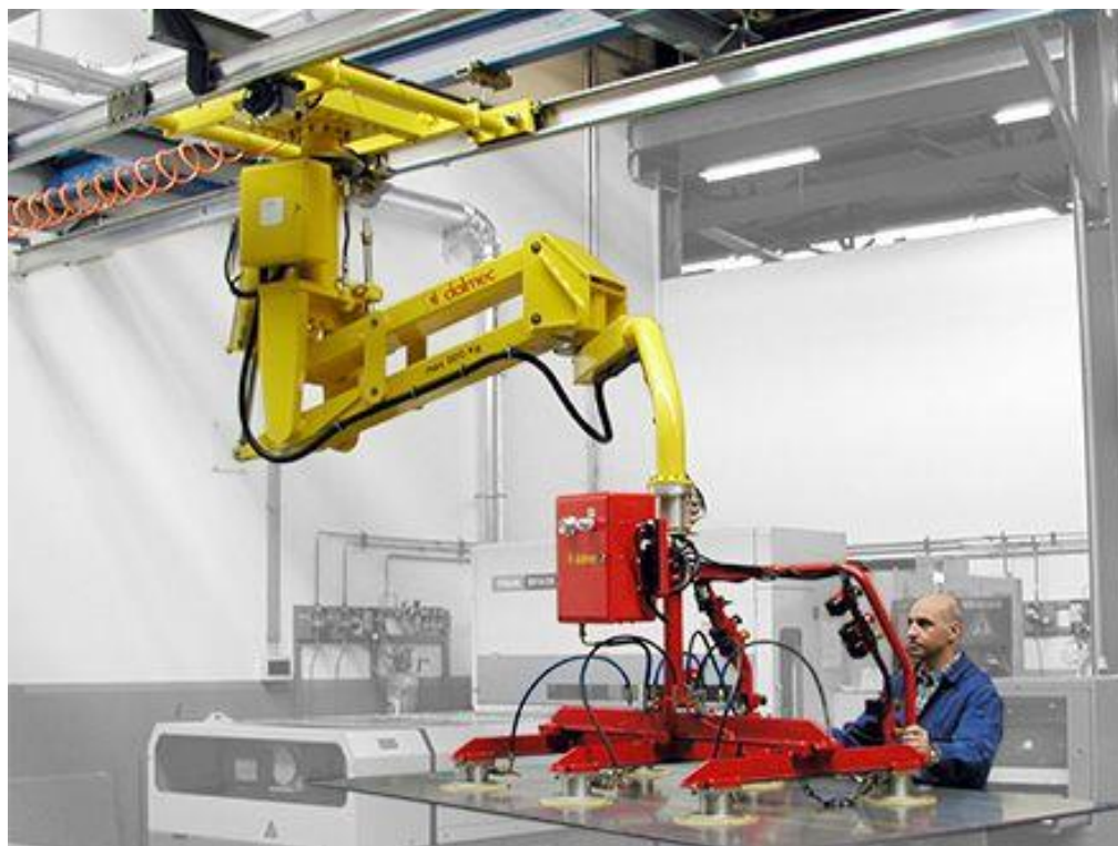
Slika 7. Mobilni stropni manipulator
