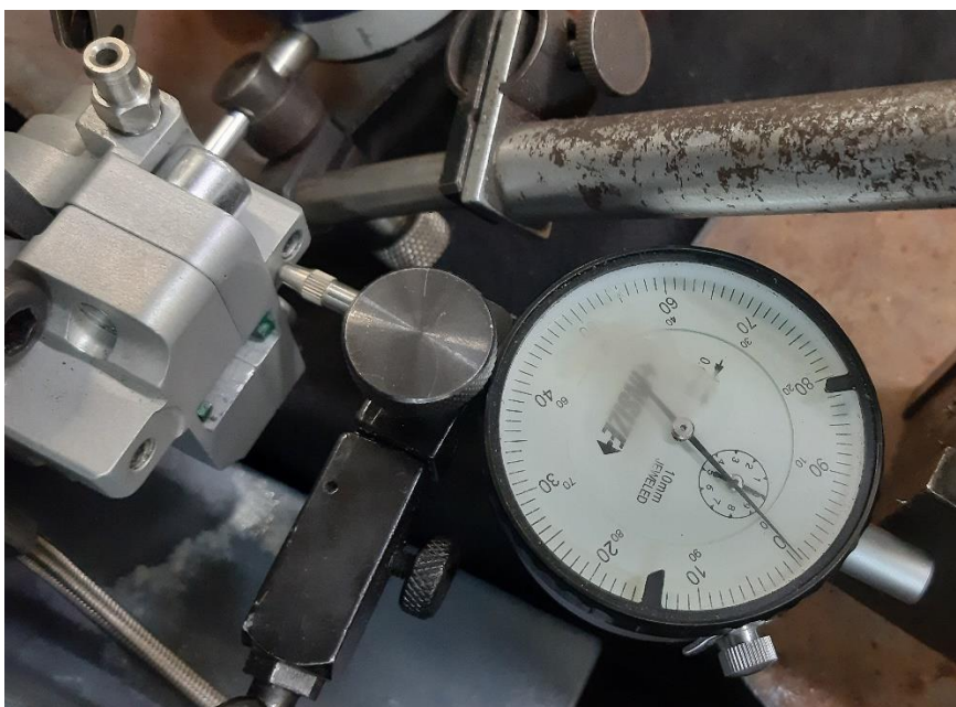
Slika 37. Mjerenje točke T5 na čeljusti stražnjih kočnica
