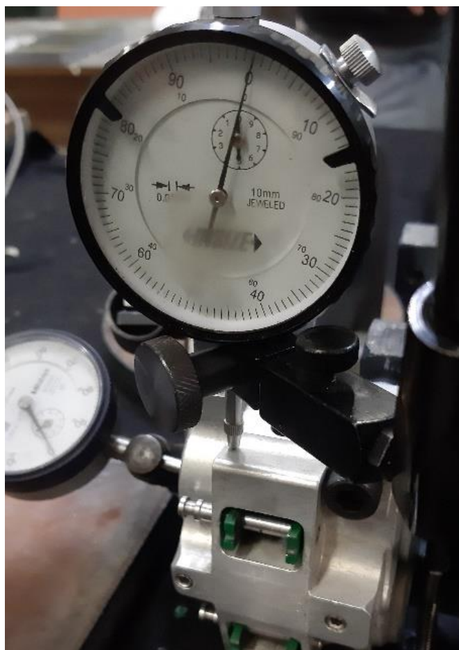
Slika 32. Mjerenje točke T4 na čeljusti prednjih kočnica
