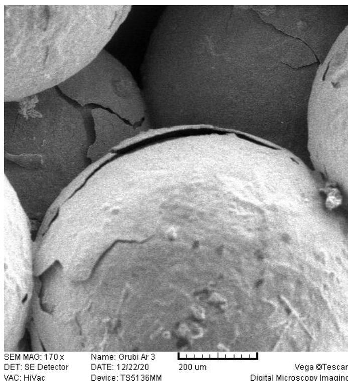
**Slika 29. Čestice uzorka sinteriranog u zaštiti argona**
