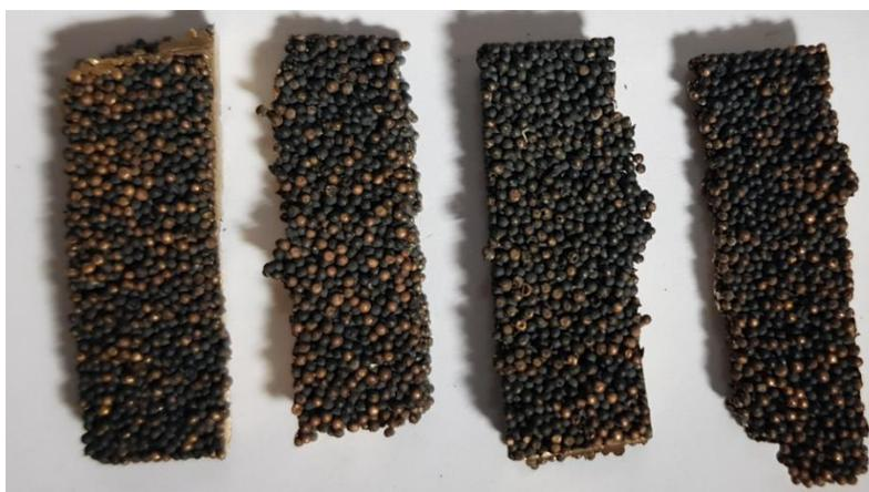
**Slika 31. Izrezani uzorci iz zaštitne atmosfere argona**
