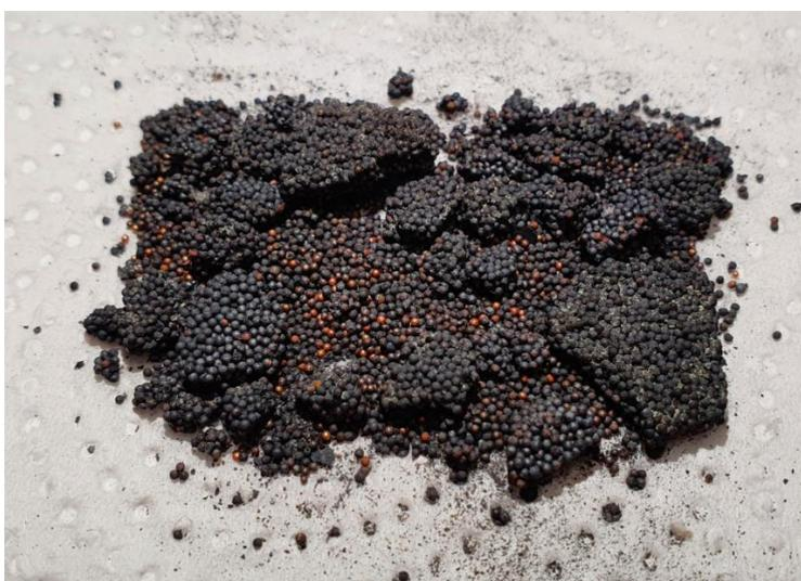
**Slika 18. Rezultat sinteriranja bez zaštitne atmosfere**
