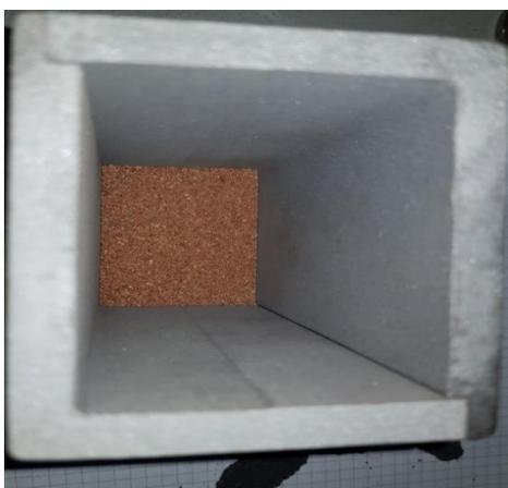
**Slika 21. Napunjeni kalup spreman za sinteriranje u vakuumu**
