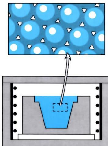
**Slika 6. Puni kalup u peći [13]**
