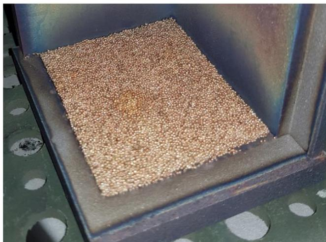
**Slika 22. Prah 600/1000 nakon sinteriranja u vakuumu**
