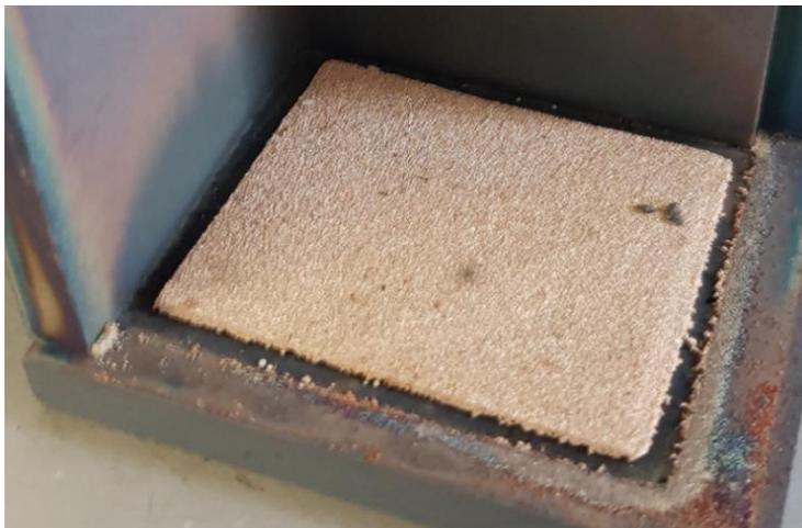
**Slika 24. Pločica praha 150/250 sinterirana u vakuumu**
