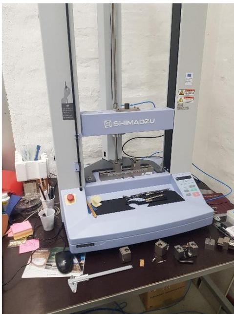
**Slika 32. Uređaj za ispitivanje SHIMADZU AG-X**
