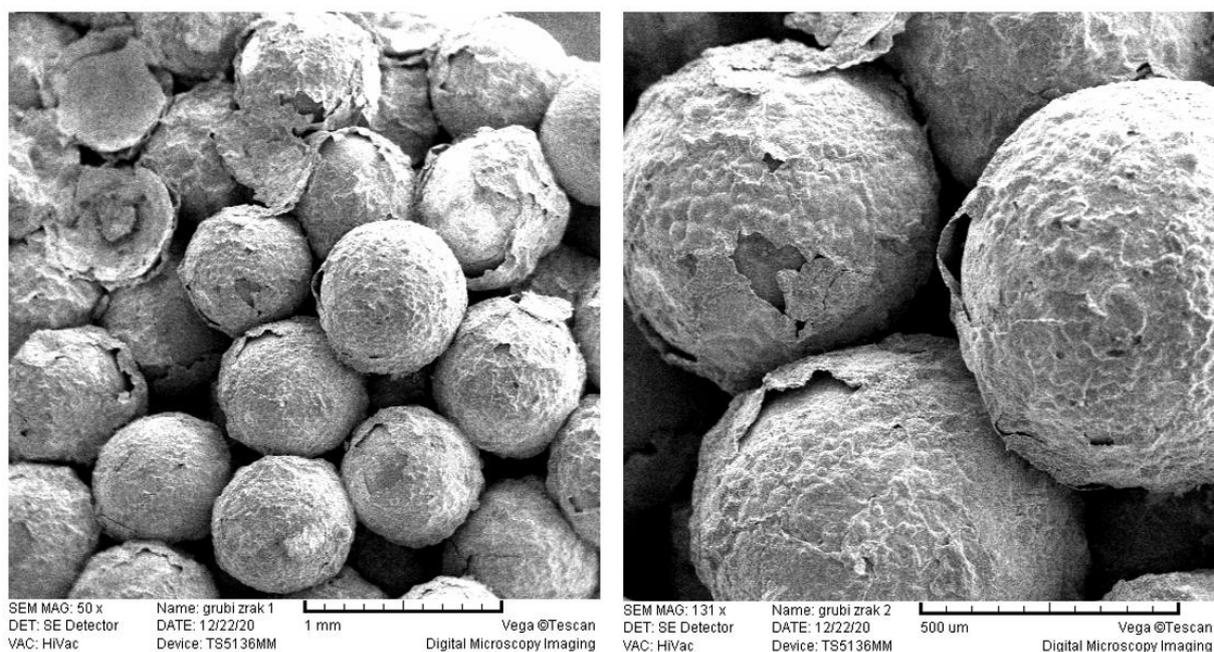
**Slika 19. Uzorak sinteriran bez zaštite snimljen SEM-om**
