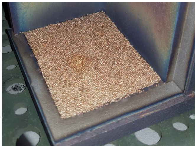
Slika 22. Prah 600/1000 nakon sinteriranja u vakuumu
