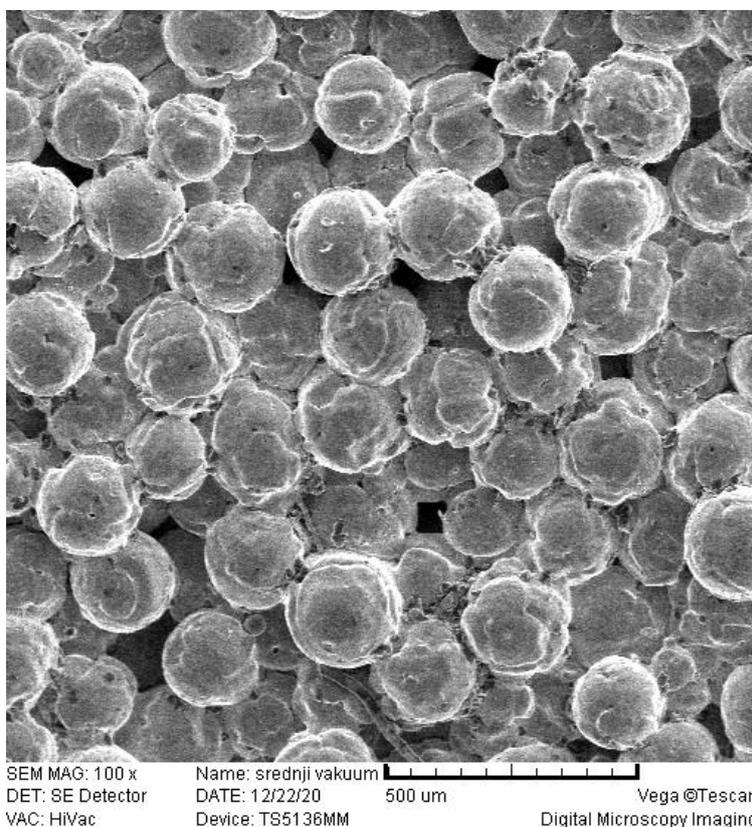
**Slika 25. Čestice praha 150/250 nakon sinteriranja u vakuumu**
