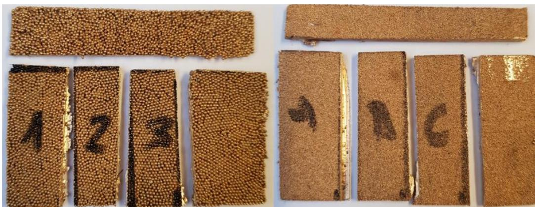
**Slika 30. Izrezani uzorci iz prahova sinteriranih u vakuumu**
