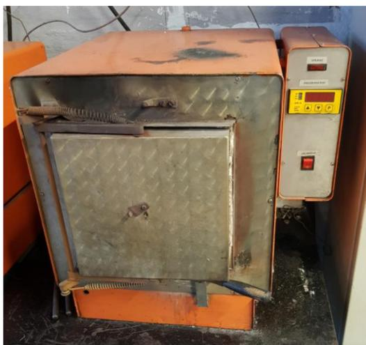
Slika 17. Komorna peć bez zaštitne atmosfere
