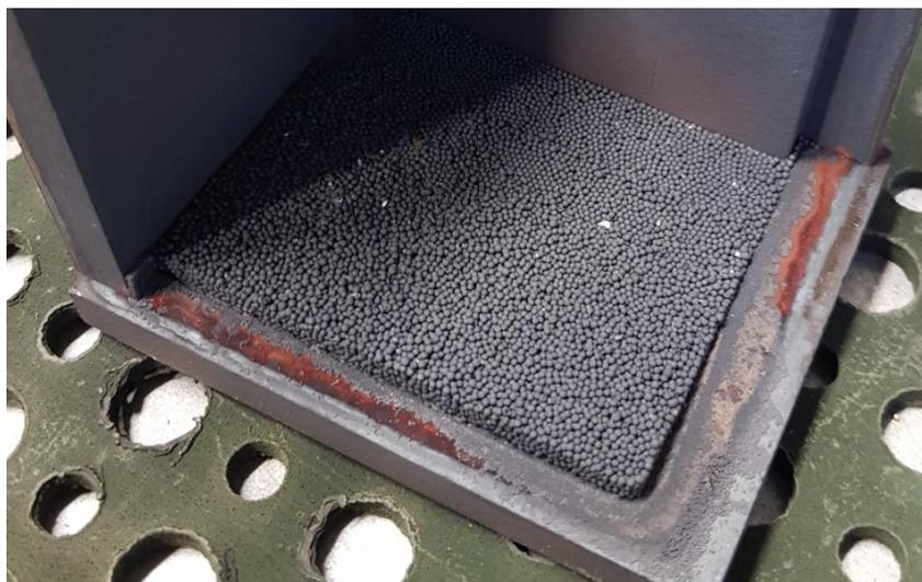
**Slika 28. Prah 600/1000 nakon sinteriranja u zaštiti argona**
