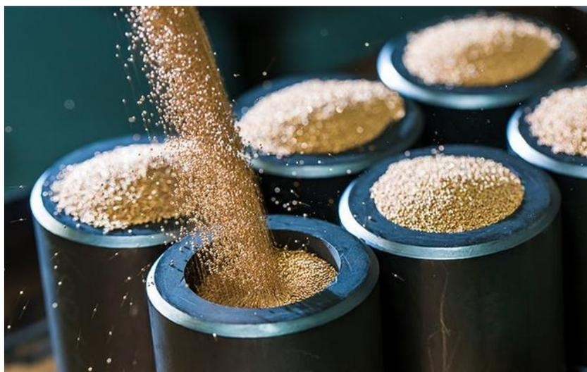
**Slika 10. Izrada filtera bez komprimiranja praha [18]**
