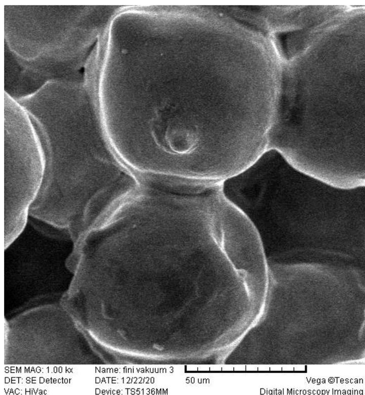
Slika 27. Čestice praha 53/90 nakon sinteriranja u vakuumu
