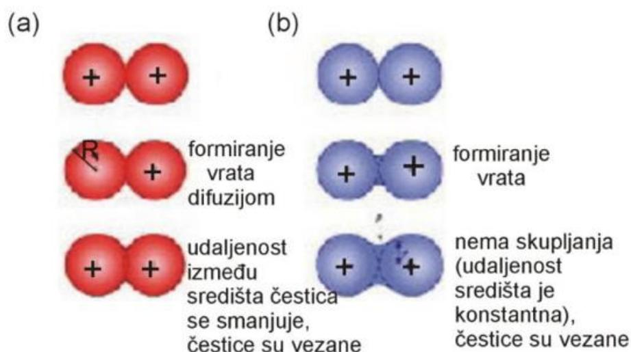
Slika 4. Prikaz osnovnih postupaka sinteriranja [7]
