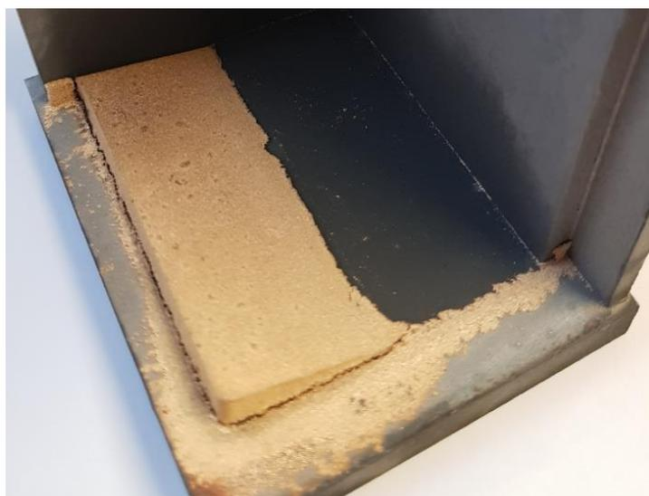
**Slika 26. Uzorak praha 53/90 nakon sinteriranja u vakuumu**
