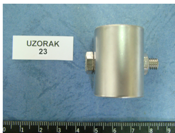
Slika 108: Uzorak 23 - prije ispitivanja - legura na bazi nikla - Inconel 600
