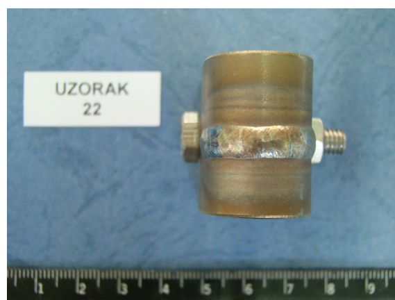
Slika 107: Uzorci 22 – prije ispitivanja - dupleks nehrđajući čelik kvalitete AISI 2304
