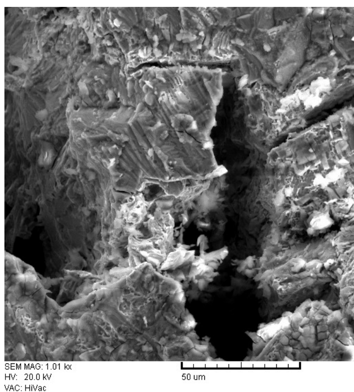
Slika 71: Površina poprečnog presjeka materijala uslijed loma snimljena SEM-om – prikaz detalja pukotine - Uzorak 4 (materijal AISI 304)
