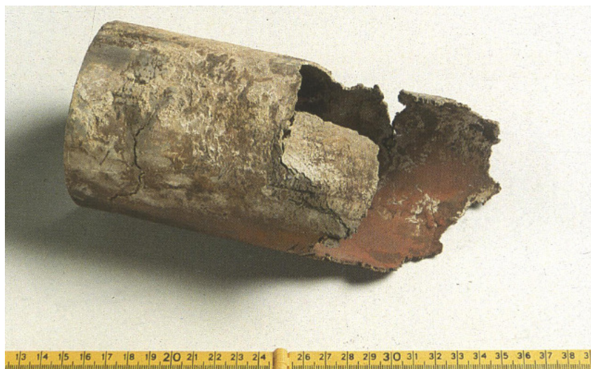
Slika 41: Kloridna napetosna korozija AISI 316 čelika – transkristalan lom [5]
