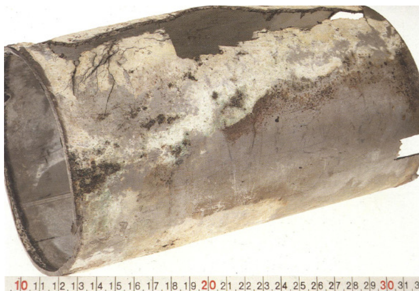
Slika 48: Primjer kloridne napetosne korozije AISI 304 čelika – transkristalan lom [5]
