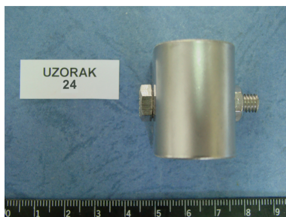
Slika 109: Uzorak 24 - prije ispitivanja - legura na bazi nikla - Incoloy 800H
