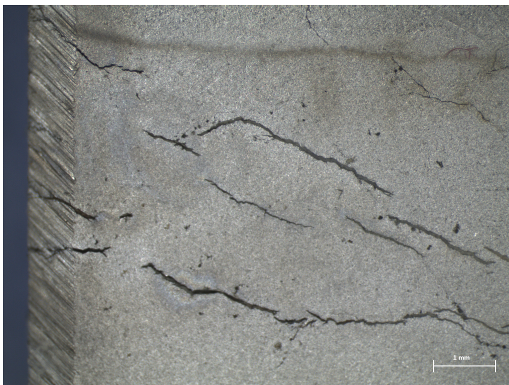
Slika 80: Pukotine izazvane napetosnom korozijom na površini i u poprečnom presjeku materijala; materijal AISI 304 – Uzorak 9 (snimljeno stereomikroskopom Leica MZ6)
