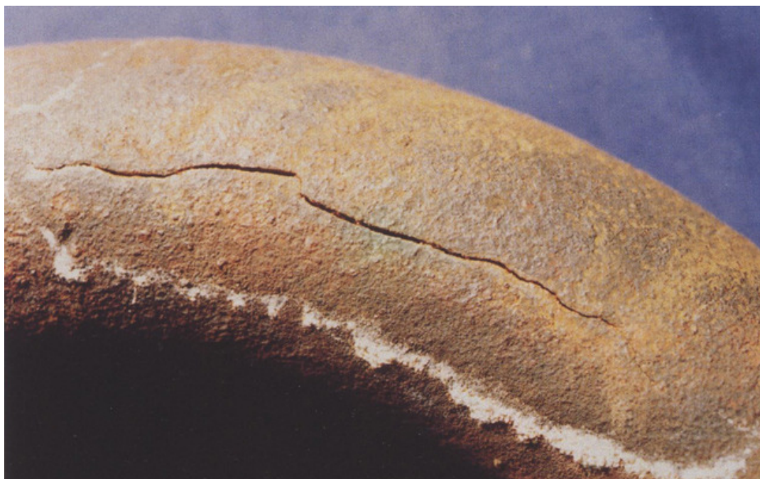
Slika 19: Primjer napetosne korozije ugljičnog čelika – interkristalni karakter loma [5]
