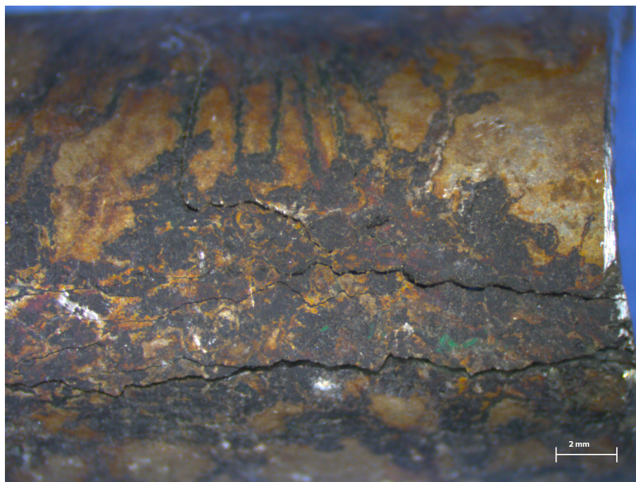
Slika 86: Snimka pukotina prije uklanjanja produkata korozije; materijal AISI 316Ti – Uzorak 5 (snimljeno stereomikroskopom Leica MZ6)
