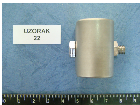
Slika 107: Uzorci 22 – prije ispitivanja - dupleks nehrđajući čelik kvalitete AISI 2304
