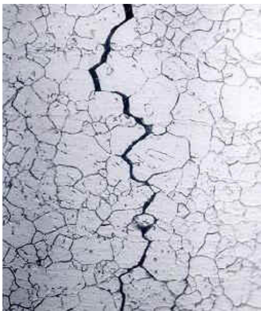
Slika 38: Napetosna korozija AISI 304 čelika – interkristalan lom [18]
