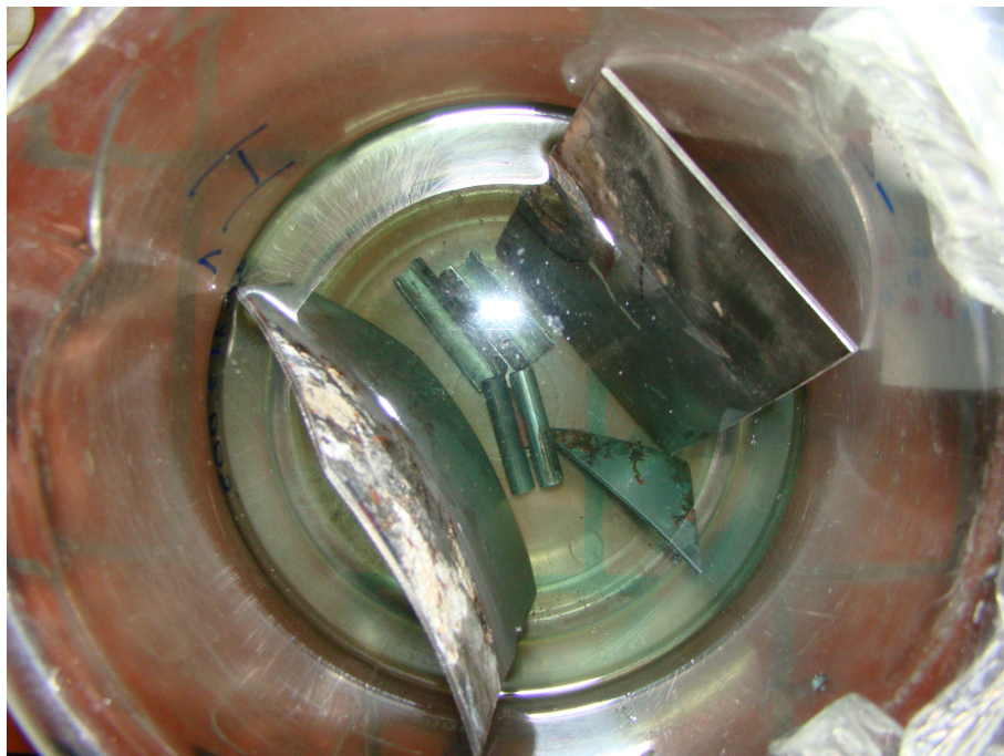
Slika 63: Kemijsko čišćenje uzoraka (uklanjanje korozijskih produkata) u otopini 30 % \text{HNO}_3 i 1,25 % HF
