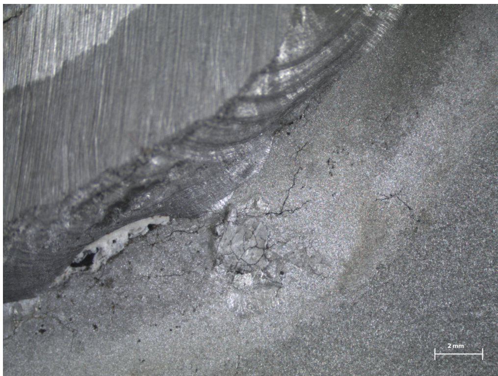
Slika 79: Pukotine izazvane napetosnom korozijom na površini i u zoni zavarenog spoja; materijal AISI 304 – Uzorak 9 (snimljeno stereomikroskopom Leica MZ6)
