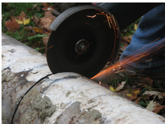
Slika 58: Postupak rezanja uzoraka
