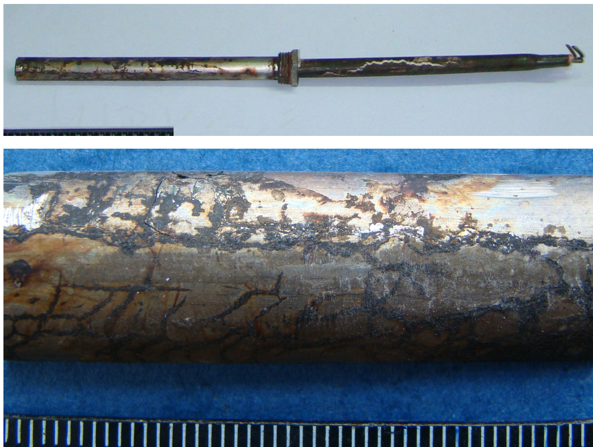
Slika 84: Zaštitna cijev grijača (Serija I) uz različita uvećanja; materijal AISI 316Ti
