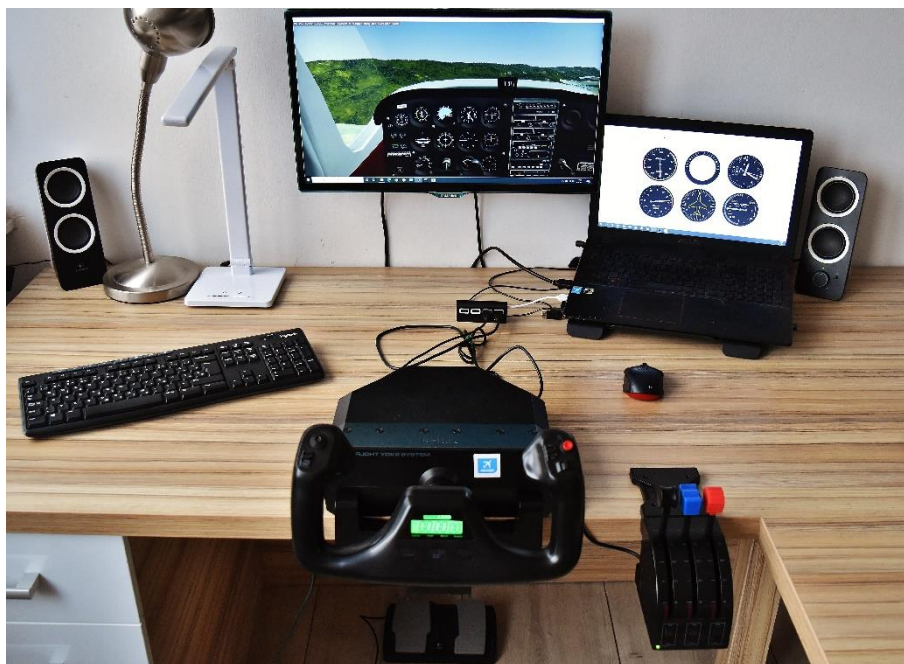
Slika 24 Simulacijska platforma na osobnom računalu
