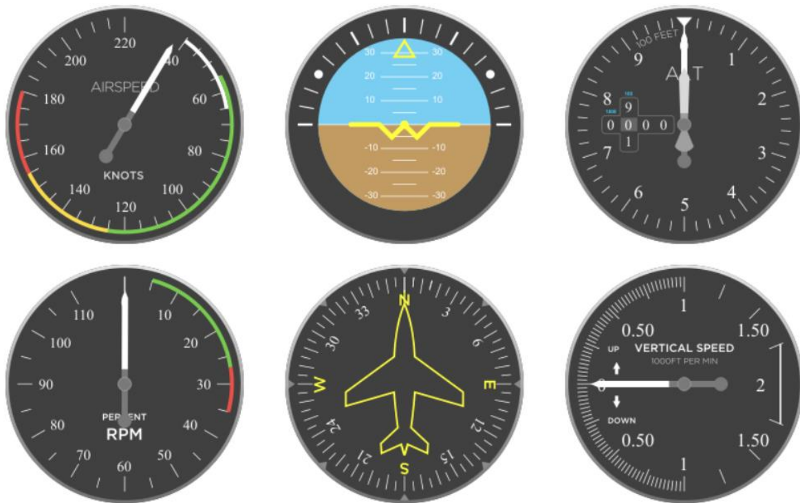
Slika 22 Prikaz instrumenata na zaslonu ispred pilota
