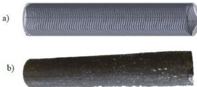
Slika 7. a) CAD model vlakna unutar matrice, b) ispisani 3D model vlakna unutar matrice [10]
