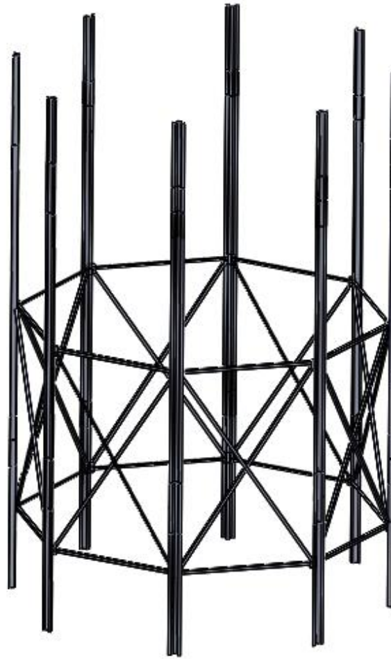
Slika 2.7. Noge silosa s ojačanjima
