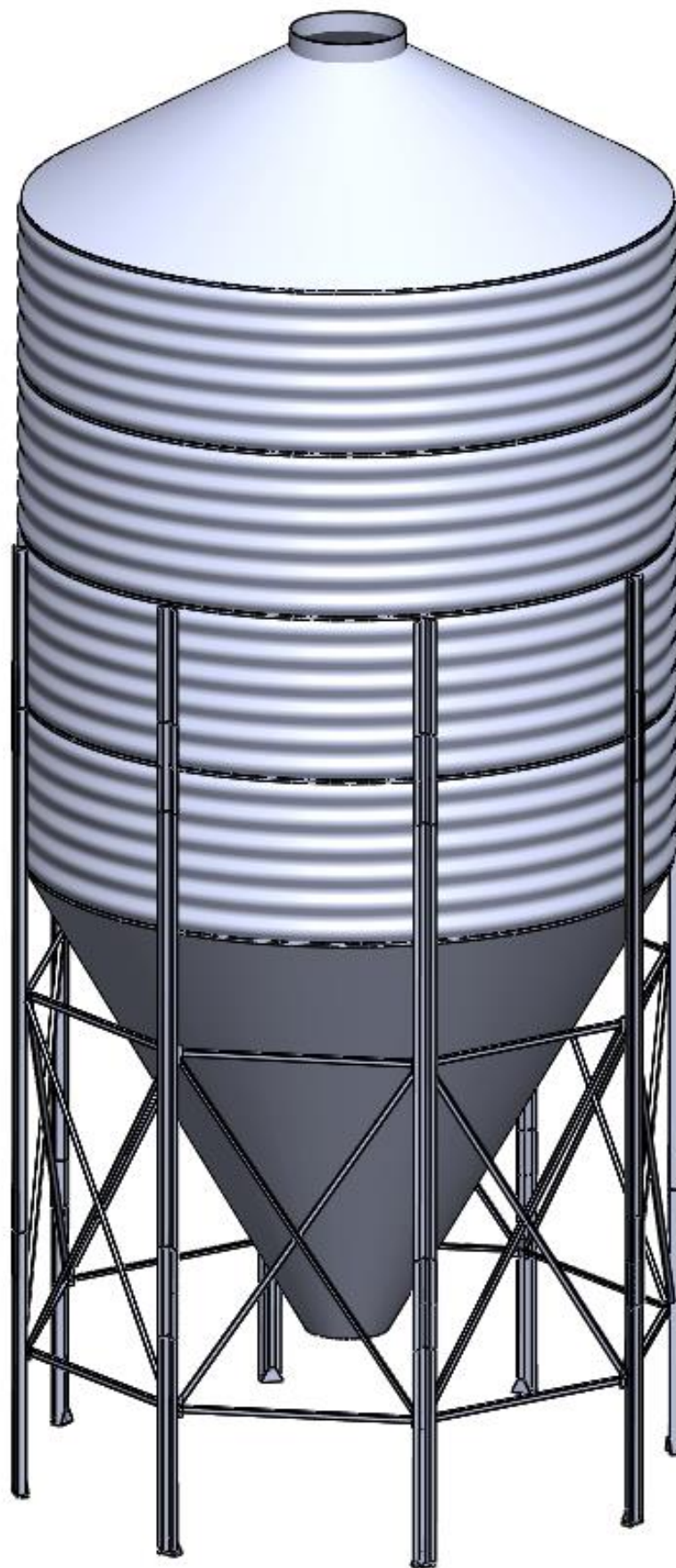
Slika 2.8. Nosiva konstrukcija silosa
