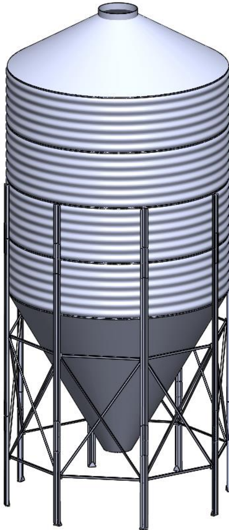
Slika 2.8. Nosiva konstrukcija silosa
