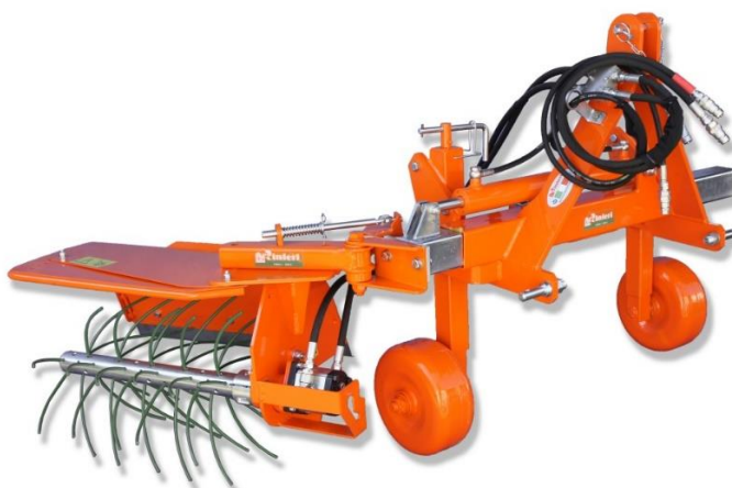
Slika 2. Stroj pogonjen traktorskom hidraulikom
