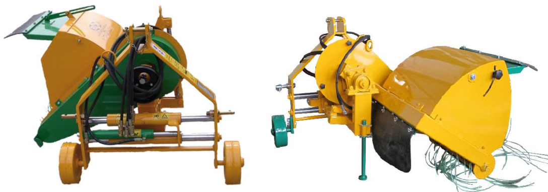
Slika 3. Stroj pogonjen direktno izlaznim vratilom traktora
