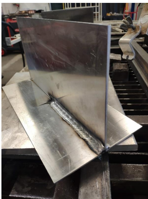
Slika 44. Zavar napravljen MIG postupkom duplim pulsom
