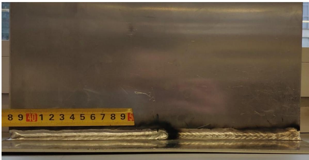
Slika 46. Prikaz cijelog zavara (lijevo-pulsno, desno-duplo pulsno)
