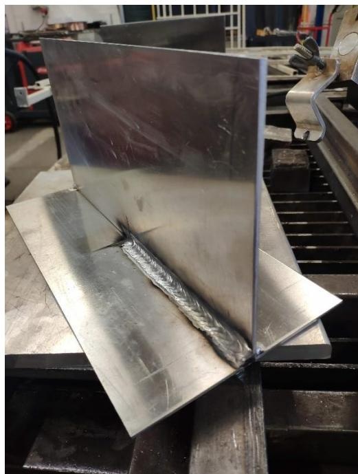
**Slika 44. Zavar napravljen MIG postupkom duplim pulsom**
