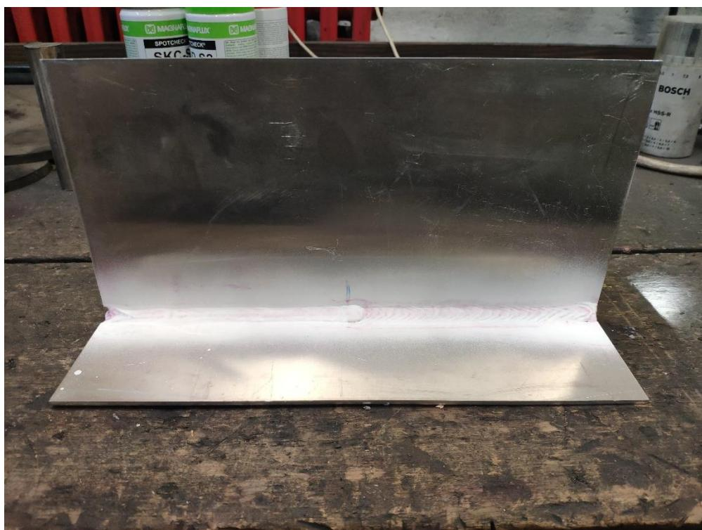
Slika 49. Zavar nakon nanošenja penetranta i razvijača
