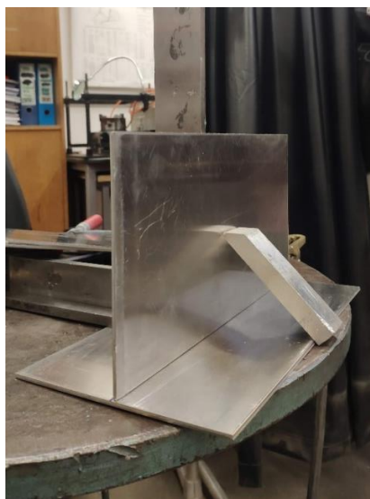
Slika 41. Prikaz položaja komada za TIG zavarivanje
