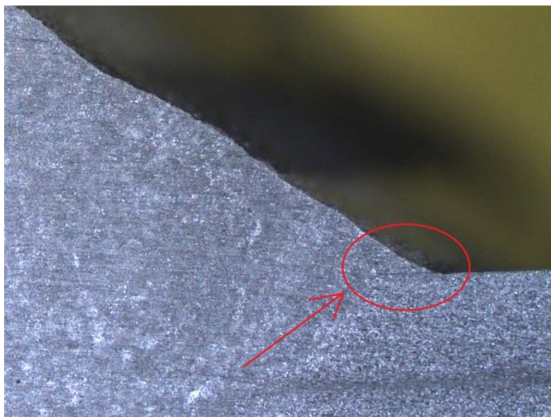
Slika 64. Pogreške u zavaru, P-GMAW
