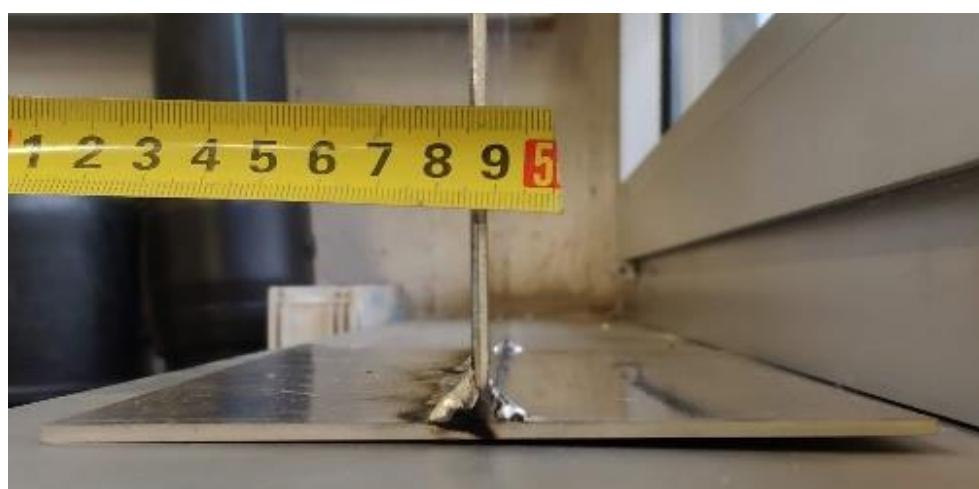
Slika 47. Prikaz deformacije zavara
