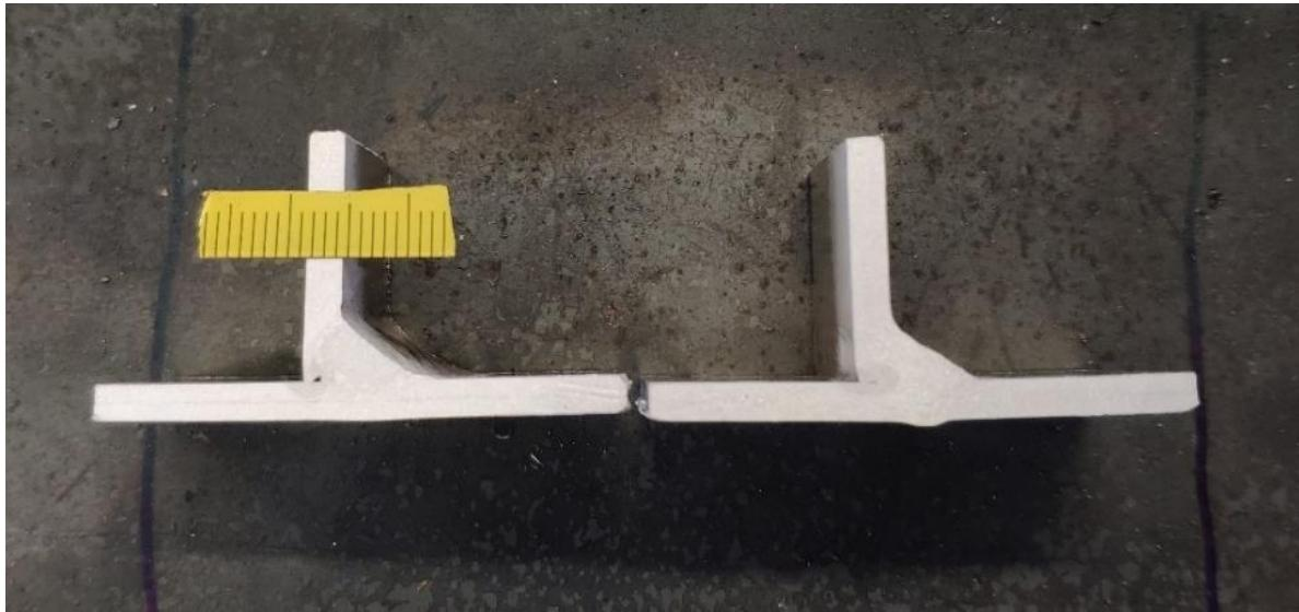
**Slika 54. Makroizbrusci nakon postupka nagrizanja**
