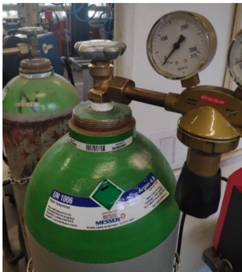
Slika 40. Boca zaštitnog plina Argon 4.8
