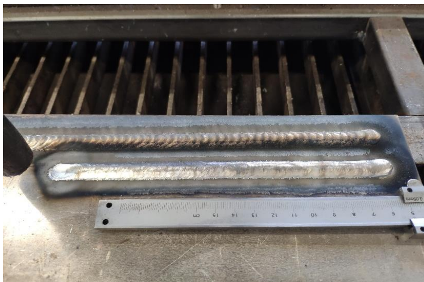
Slika 33. Prikaz dobivenih navara
