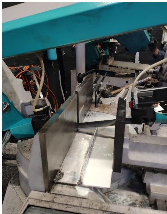
Slika 52. Strojno rezanje makroizbrusaka na tračnoj pili
