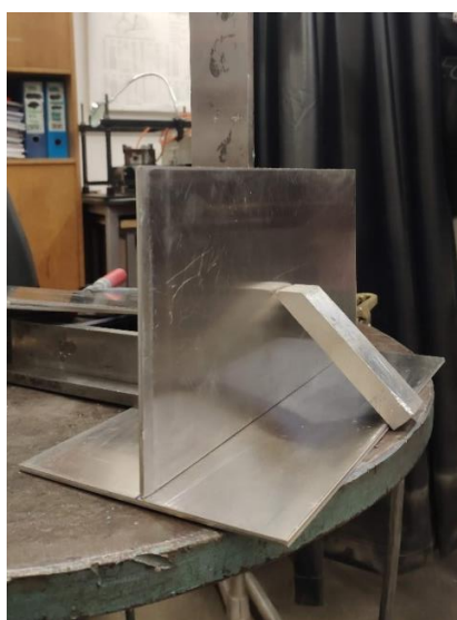
Slika 41. Prikaz položaja komada za TIG zavarivanje
