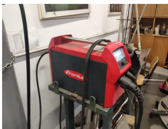
Slika 38. Fronius MagicWave 230i EF
