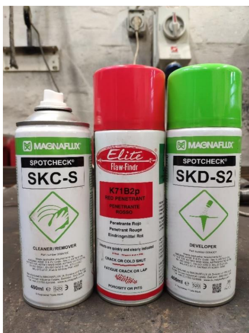
Slika 48. Sredstva korištena prilikom ispitivanja penetrantima
