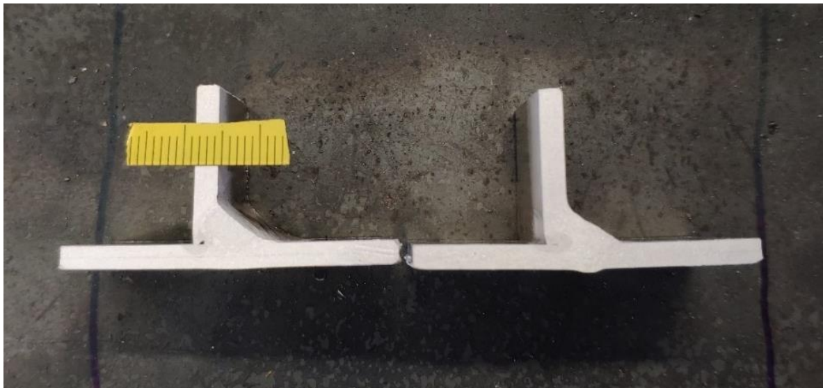
Slika 54. Makroizbrusci nakon postupka nagrivanja
