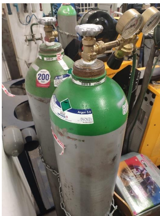
Slika 32. Boca zaštitnog plina Argon 5.0
