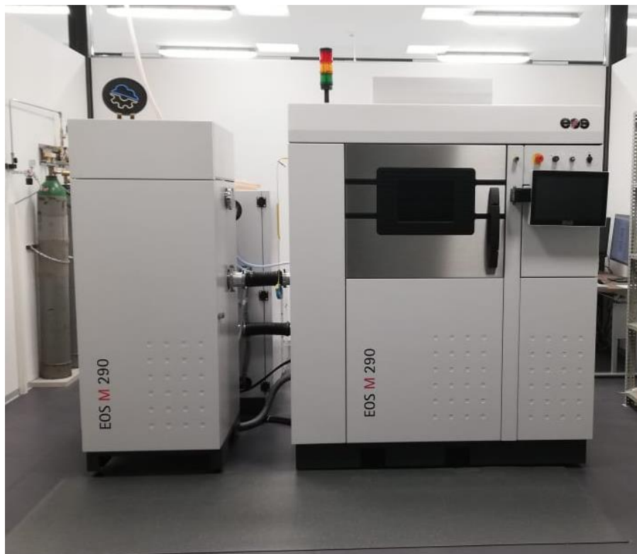
Slika 7. Printer EOS M 290 (Metalska jezgra Čakovec)
