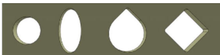
Slika 13. Različiti oblici presjeka kanala za koje, do određenog iznosa, nije potrebna potporna struktura [3]
