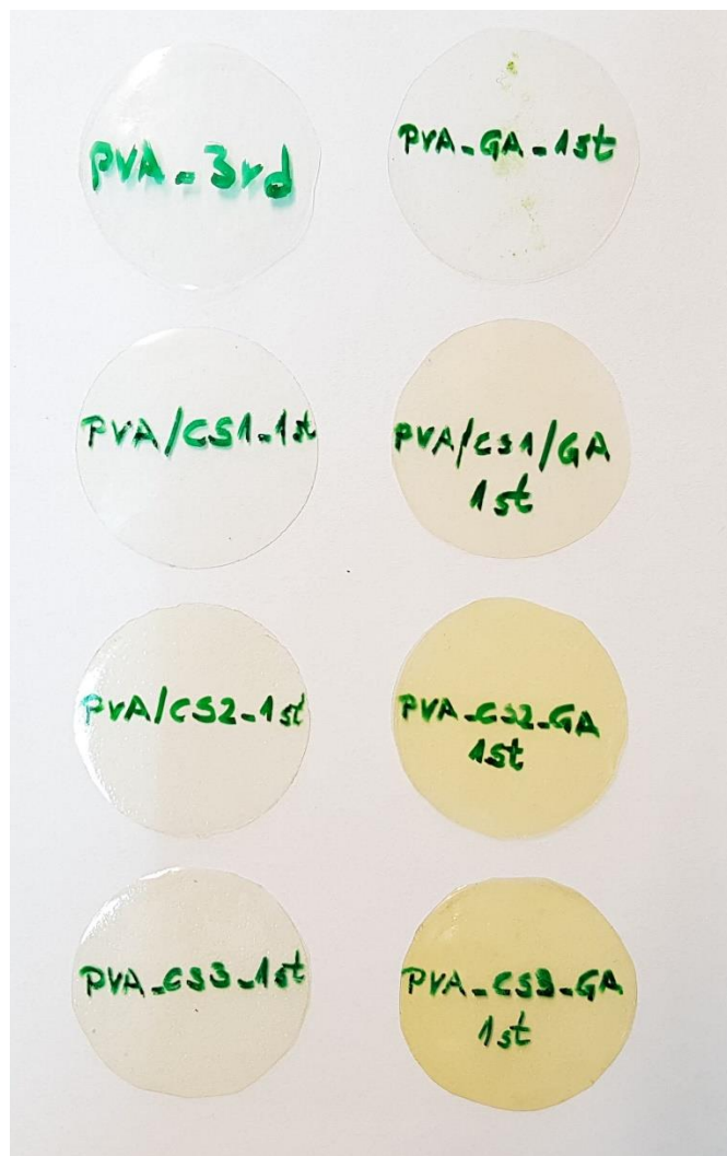
Slika 8.1 Ispitna tijela izrezana iz folija
