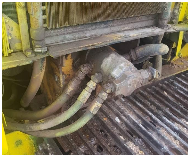
Slika 3.6. Pumpa tvrtke Webster postavljena na stroj
