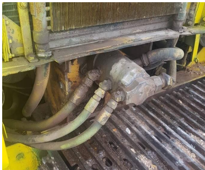
Slika 3.6. Pumpa tvrtke Webster postavljena na stroj
