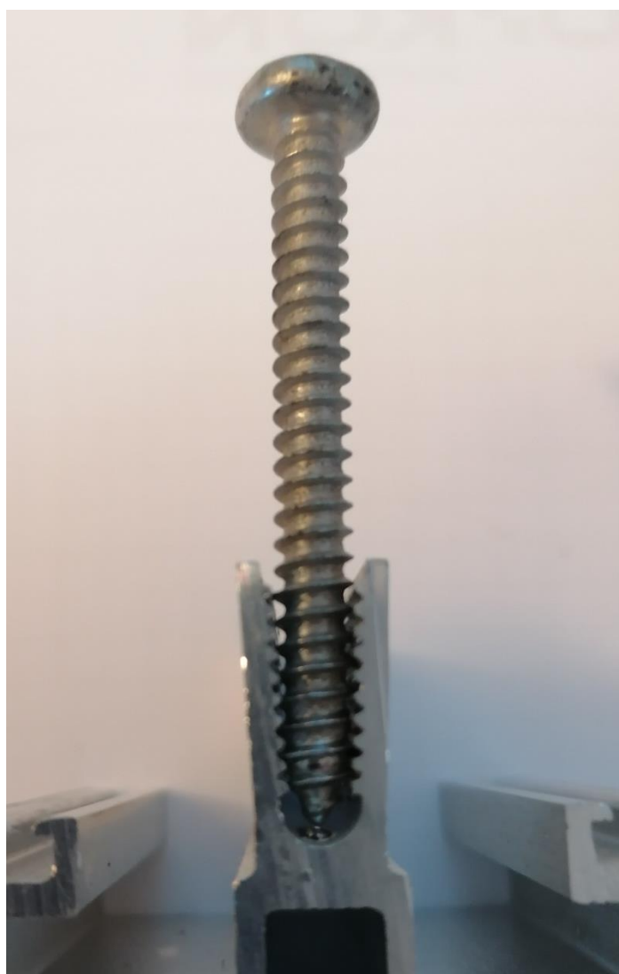
Slika 53. Deformacija stijenke profila izazvana pritezanjem vijka
