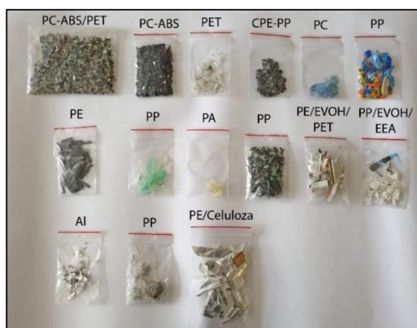
**Slika 16. Prikaz uzoraka korištenih u FTIR analizi Pos-Plast otpada**
