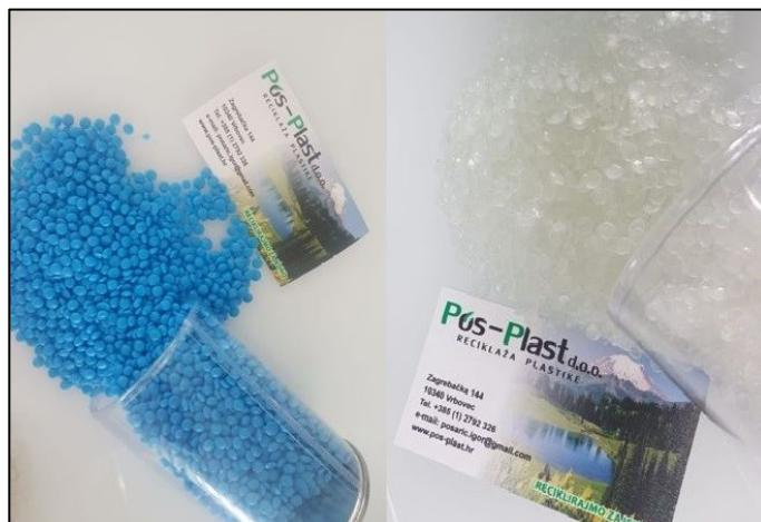
**Slika 15. Proizvodi dobiveni nakon mehaničke obrade u Pos-Plastu-u [26]**
