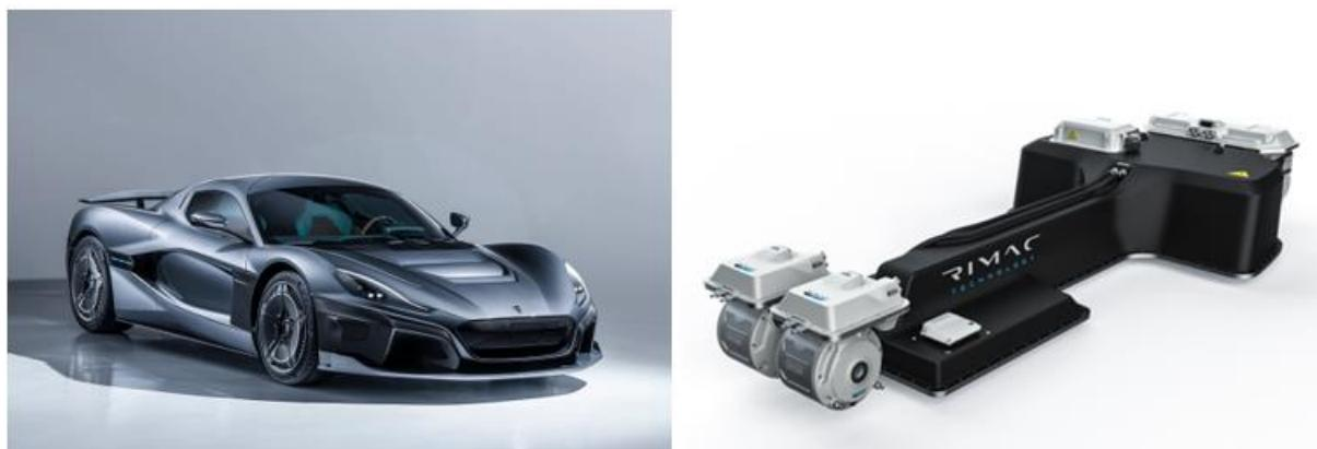
**Slika 1.2. Rimac C-Two hiper-automobil (lijevo); Rimac C-Two baterijski sustav (desno) [4]**
