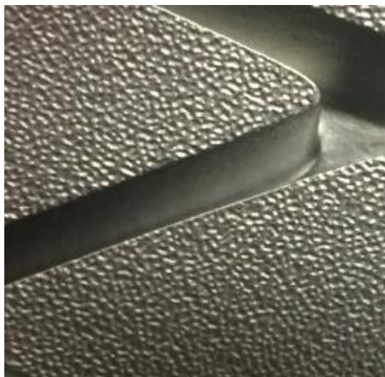
Slika 11. Završna obrada žiga kalupne šupljine u svrhu postizanja teksture [8]
