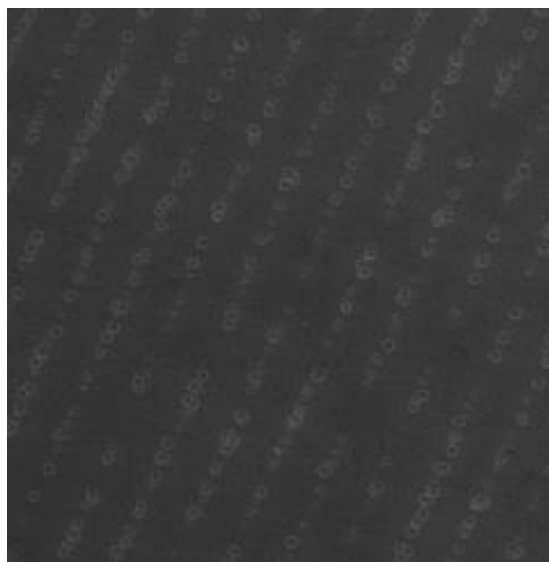
Slika 18. SEM snimka površine legure titanija nakon laserskog graviranja [20]
