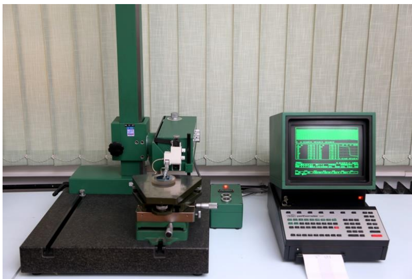
Slika 32. Uređaj za mjerenje hrapavosti Perthometer S8P
