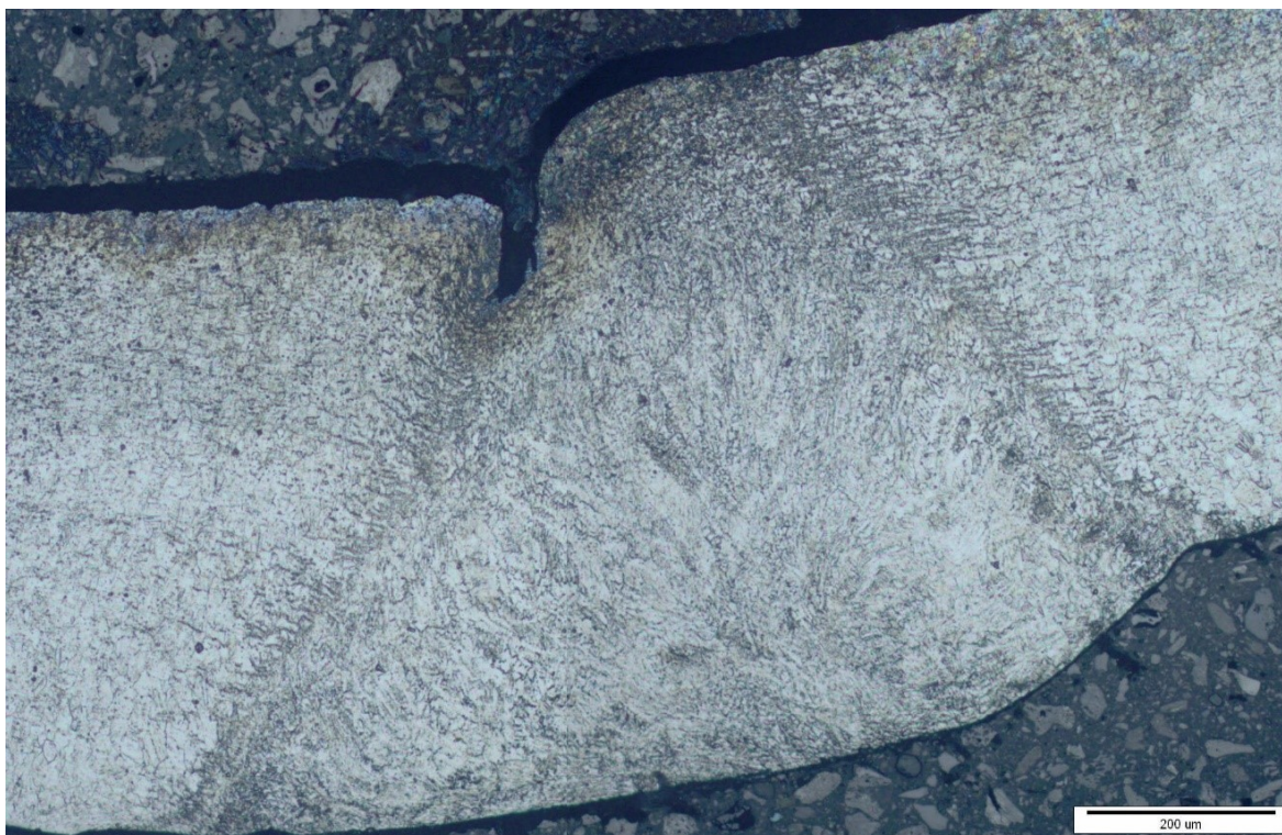
Slika 44. Makrostruktura zavarenog spoja
