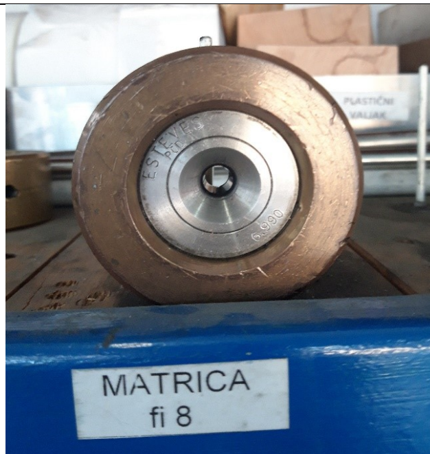
Slika 29. Matrica za provlačenje
