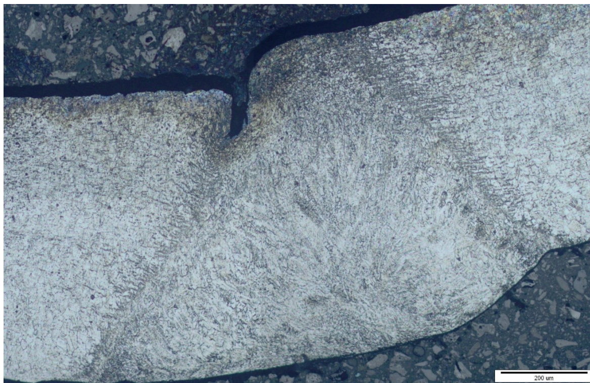
Slika 44. Makrostruktura zavarenog spoja
