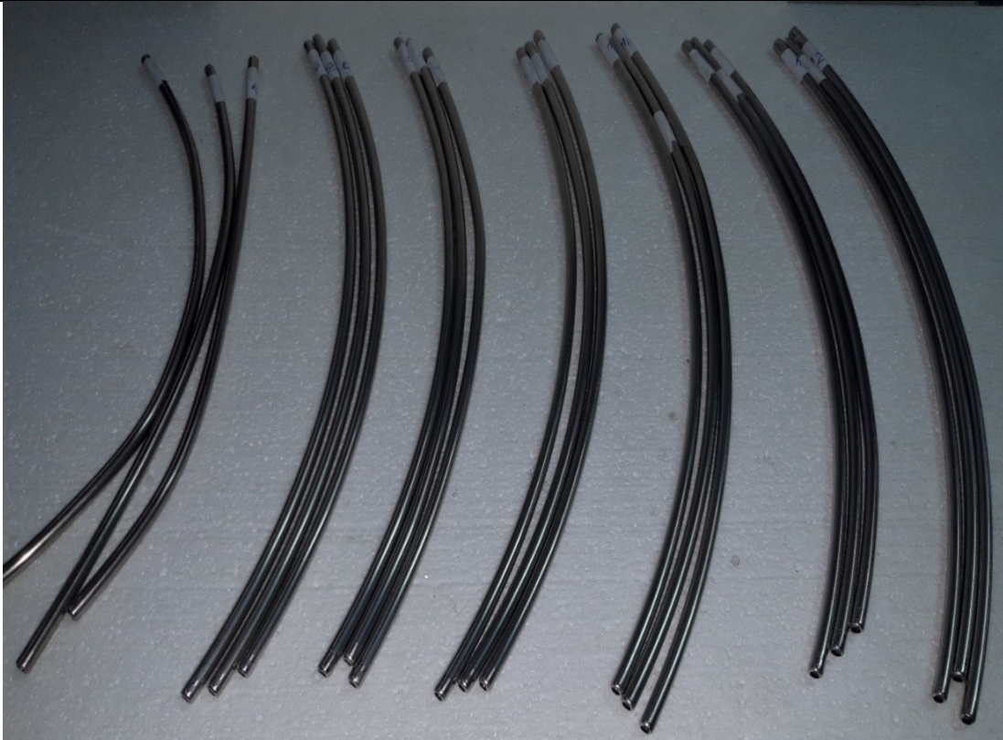
Slika 74. Uzorci za ispitivanje prije savijanja
