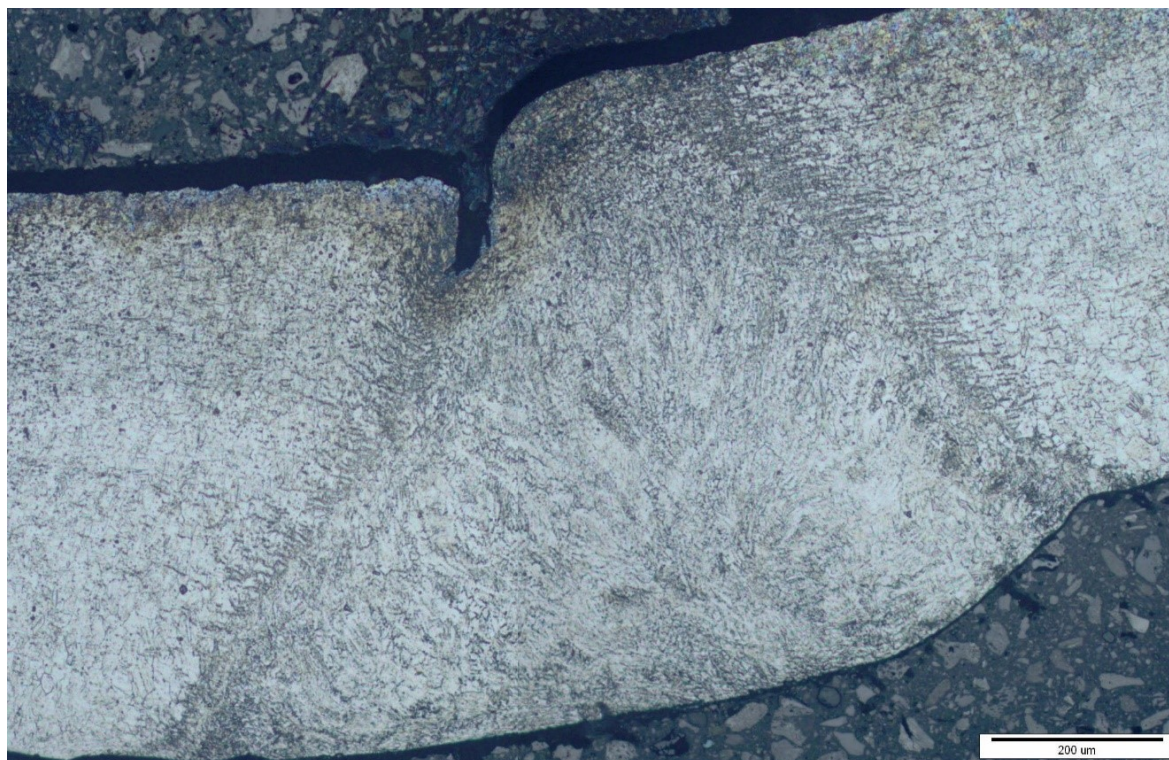
Slika 44. Makrostruktura zavarenog spoja
