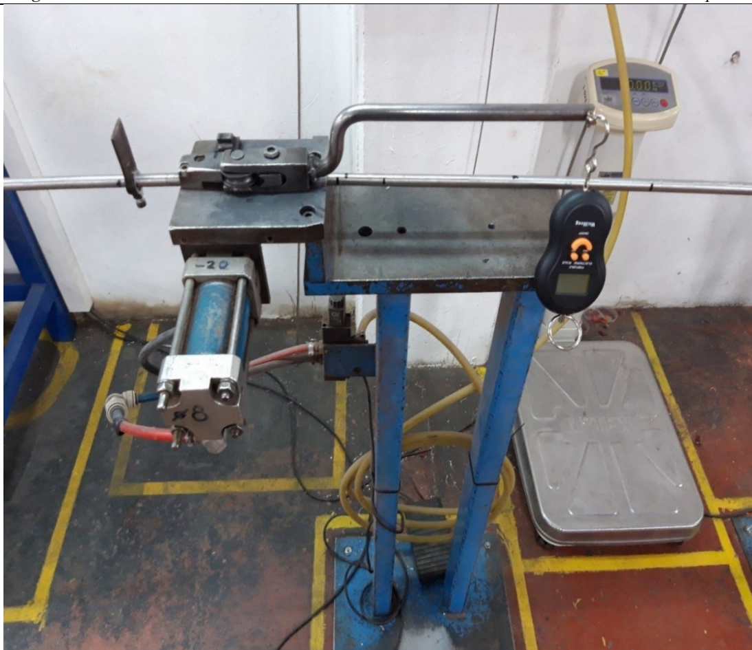
Slika 73. Naprava za ručno savijanje cijevi
