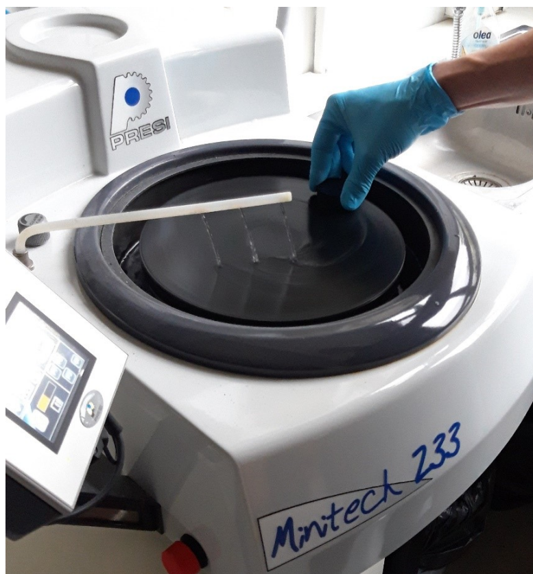
Slika 41. Uređaj za brušenje MINITECH 233
