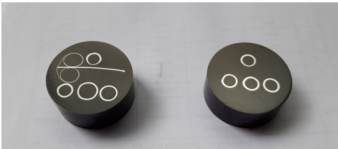
Slika 39. Uzorci zaliveni u polimernu masu
