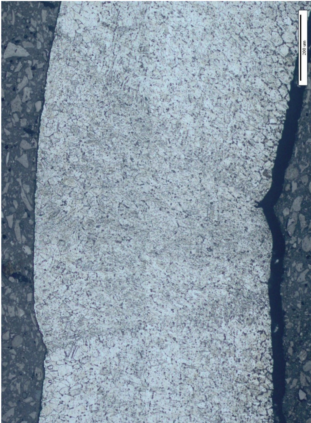
Slika 55. Mikrostruktura zavarenog spoja nakon rastvornog žarenja; v=0,85 m/min pri većem povećanju
