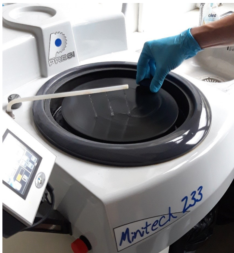
Slika 41. Uređaj za brušenje MINITECH 233
