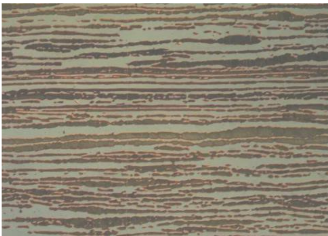
Slika 7. Mikrostruktura dupleks čelika [3]
