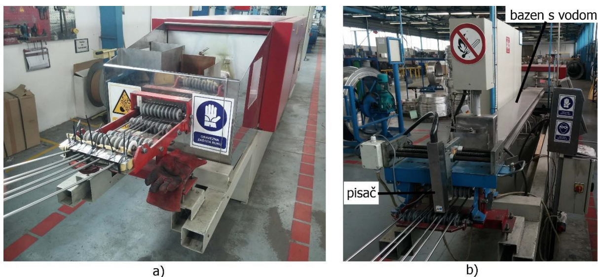
Slika 34. Ulaz cijevi u peć (a) te pisač (b) [10]
