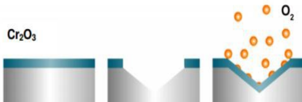
Slika 2. Samoobnavljanje pasivnog filma kromovih oksida na nehrđajućem čeliku [4]
