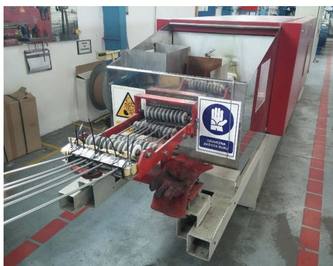
Slika 34. Ulaz cijevi u peć (a) te pisač (b) [10]
