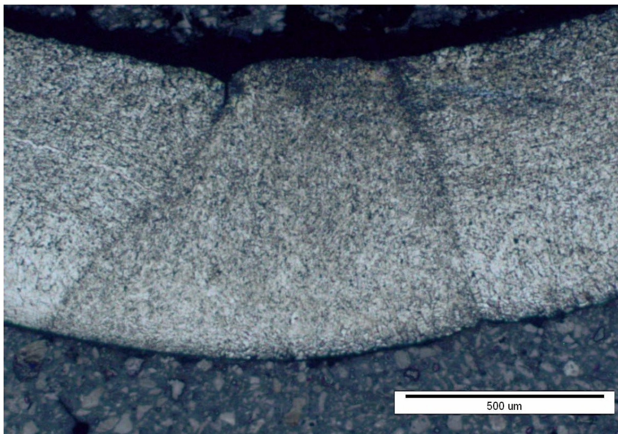
Slika 63. Mikrostruktura zavarenog spoja nakon rastvornog žarenja; v=1,10 m/min
