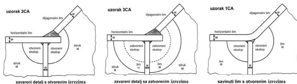
Slika 2.50 Konfiguracije detalja zgloba [25]
