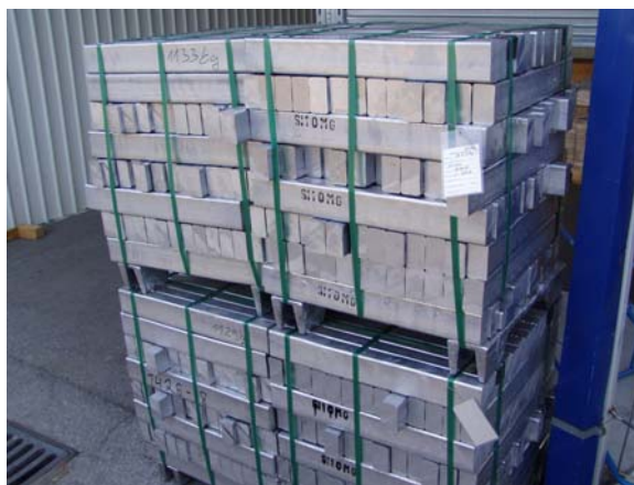
Slika 6 - 3: Oblik isporuke sirovine 2 - kontinuirano ljevani ingoti
