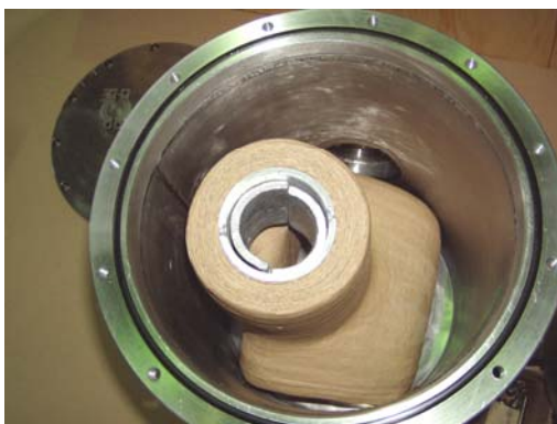
Slika 6 - 17: Umetnut uzorak 3 u posudu prije zatvaranja i vakuumiranja
