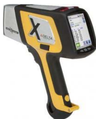
Slika 5 - 1: Prijenosni XRF uređaj Innov-X DELTA
