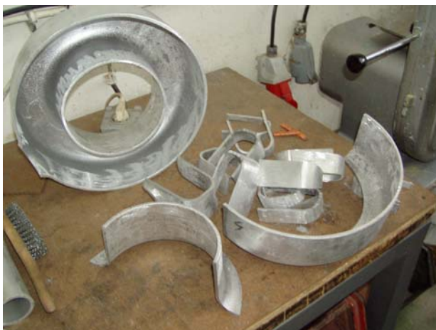
Slika 6 - 9: Izrezani dijelovi torusa - uzorak 2
