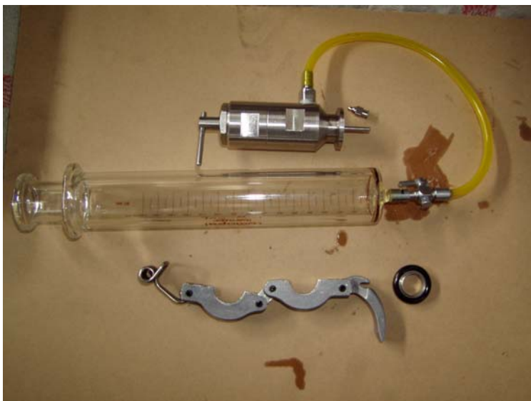
Slika 3 - 2: Pribor za uzimanje uzoraka transformatorskog ulja
