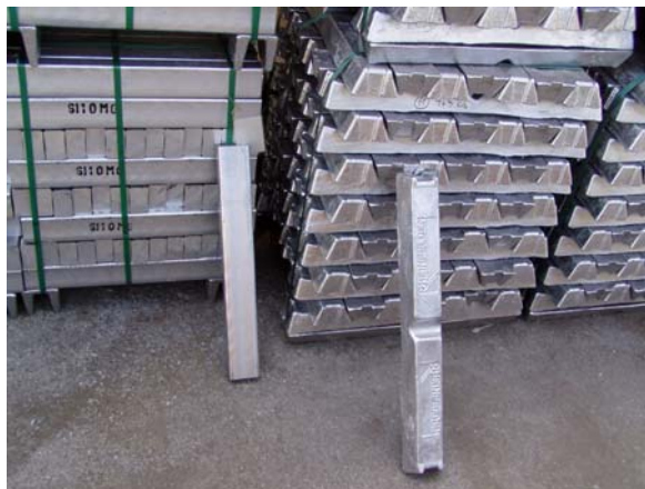
Slika 6 - 2: Oblik isporuke sirovine 1- ljevani ingoti
