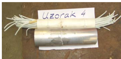
Slika 6 - 13: Uzorak 4 – svitak žica obložen nomex papirom (izvan zavarene cijevi)
