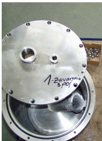
Slika 6 - 7: Uzorak 1 pripremljen za vakumiranje
