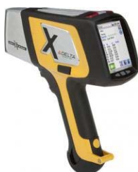
Slika 5 - 1: Prijenosni XRF uređaj Innov-X DELTA
